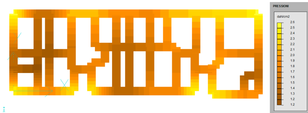
Figura 5.14-Pressioni sul terreno-Edificio a pannelli
