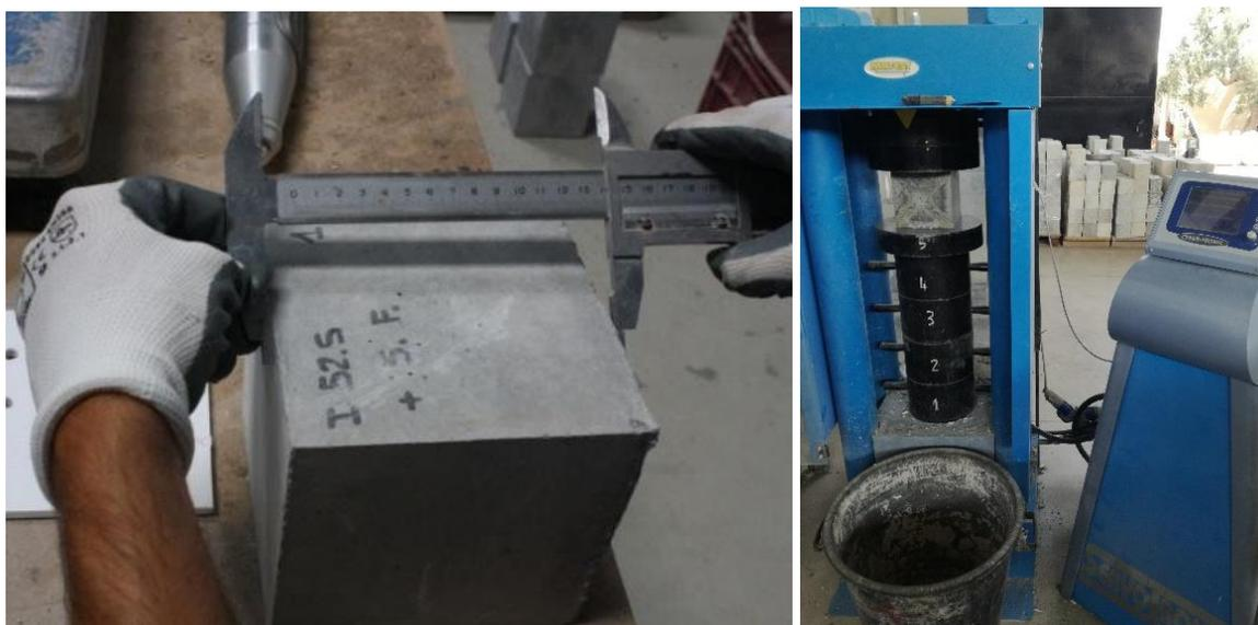
Figura 97: strumentazione utilizzata per la prova di resistenza a compressione
