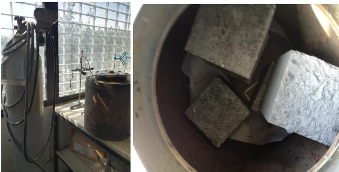
Figura 99: strumentazione per la prova di resistenza alla carbonatazione
