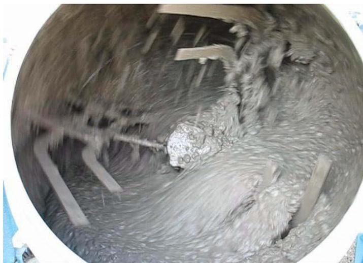
*Figura 60: operazioni di betonaggio*
