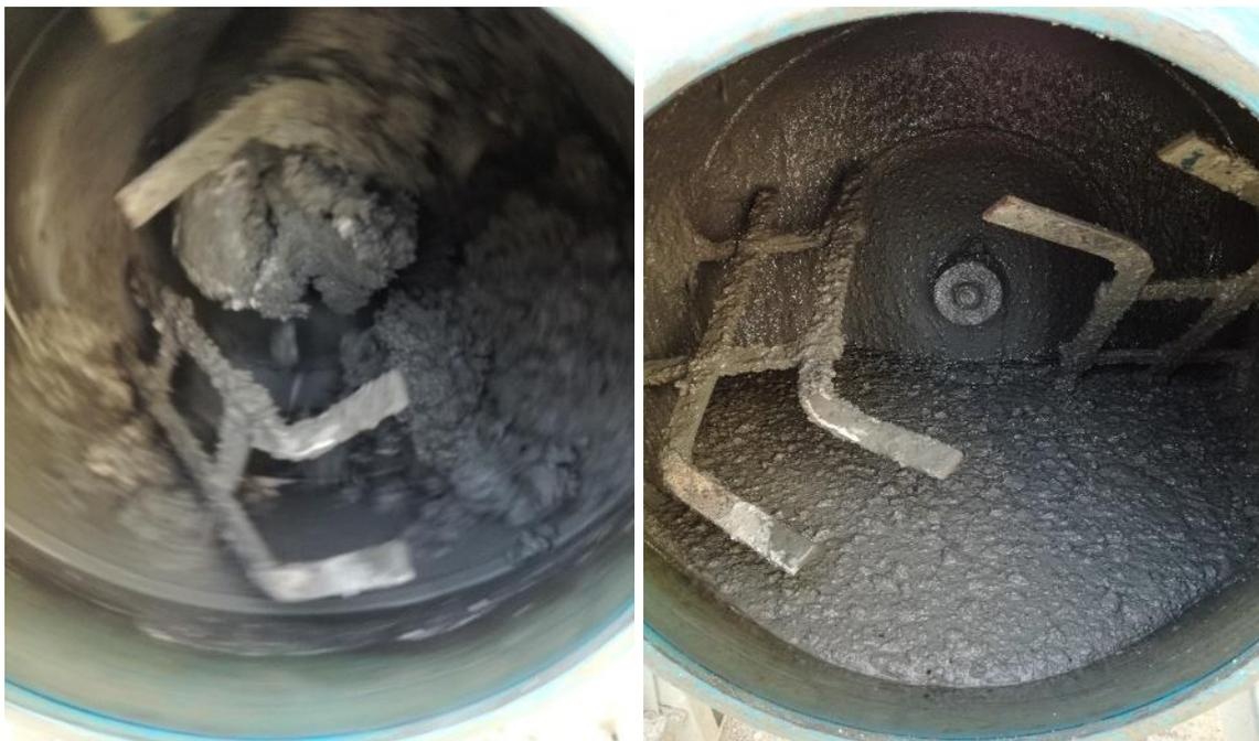
Figura 110: differenza impasto cementizio senza additivo (sinistra) e con additivo (destra) superfluidificante
