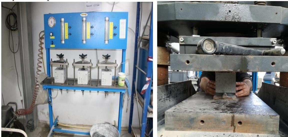
Figura 98: strumentazione per la prova di penetrazione dell'acqua (sinistra) e pressa per taglio (destra)
