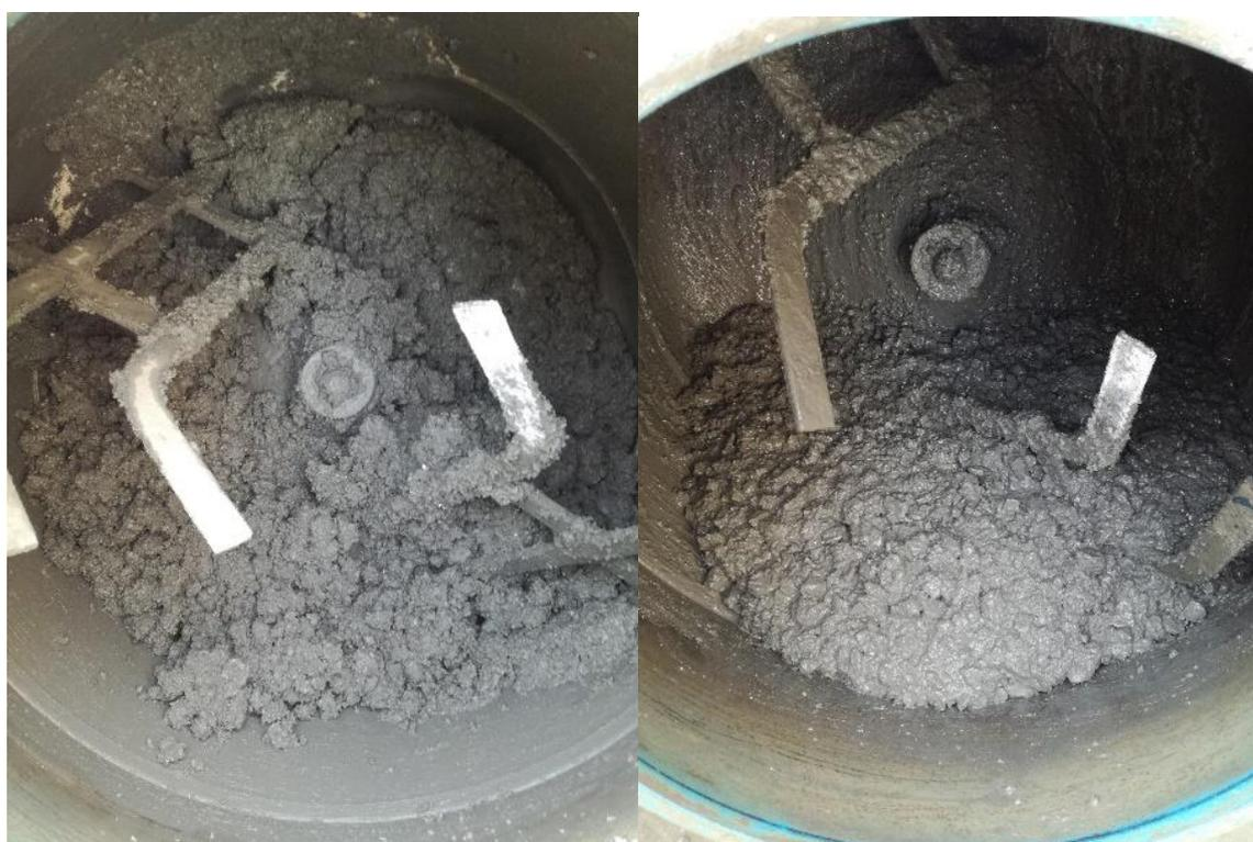
Figura 101: differenza impasto cementizio senza additivo (sinistra) e con additivo (destra) superfluidificante
