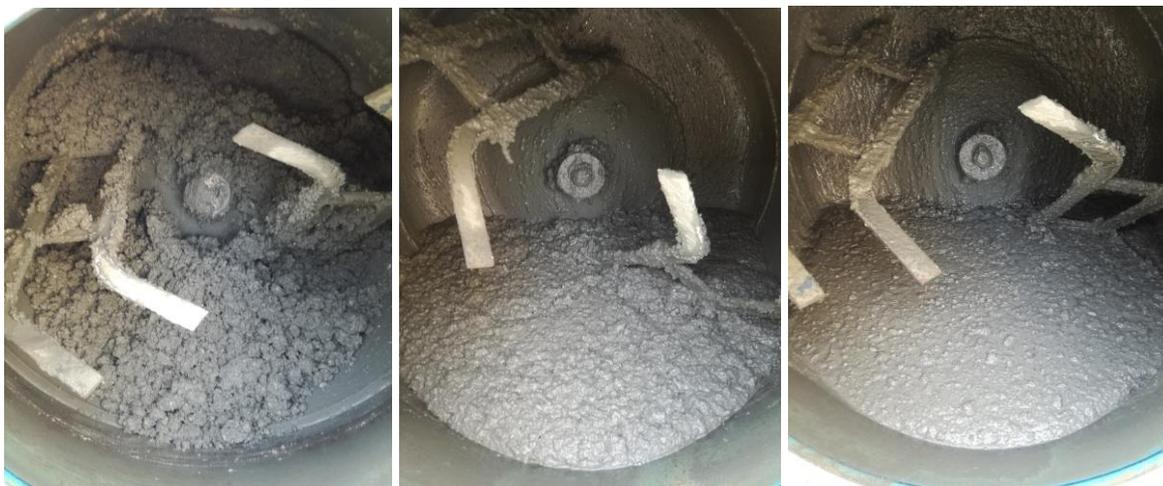
Figura 113: differenza impasto cementizio senza additivo (sinistra) e con additivo superfluidificante (centro) e con aggiunta finale di acqua (destra)
