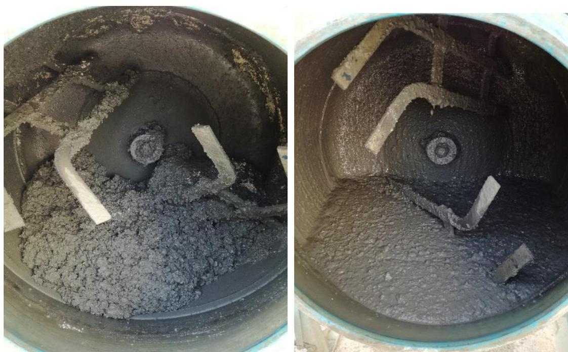
Figura 106: differenza impasto cementizio senza additivo (sinistra) e con additivo (destra) superfluidificante
