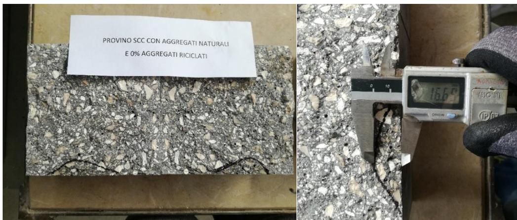
Figura 116: prova di penetrazione all'acqua – provino SCC 0% aggregati riciclati
