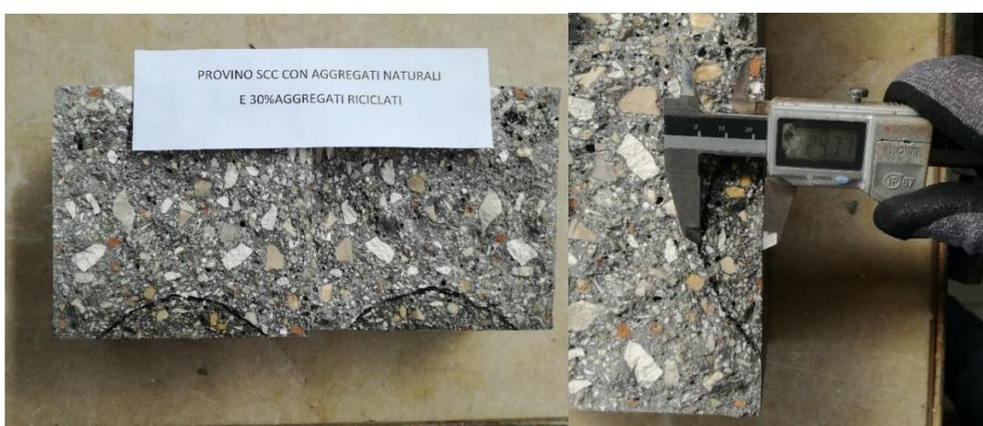
Figura 118: prova di penetrazione all'acqua – provino SCC 30% aggregati riciclati
