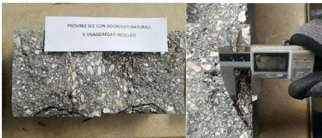
Figura 117: prova di penetrazione all'acqua – provino SCC 5% aggregati riciclati
