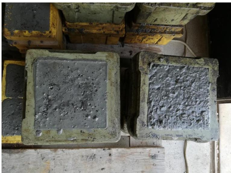
Figura 104: differenza visiva tra provino vibrato (sinistra) e provino non vibrato (destra)
