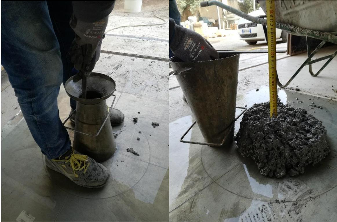
*Figura 102: costipamento del calcestruzzo e “slump test”*
