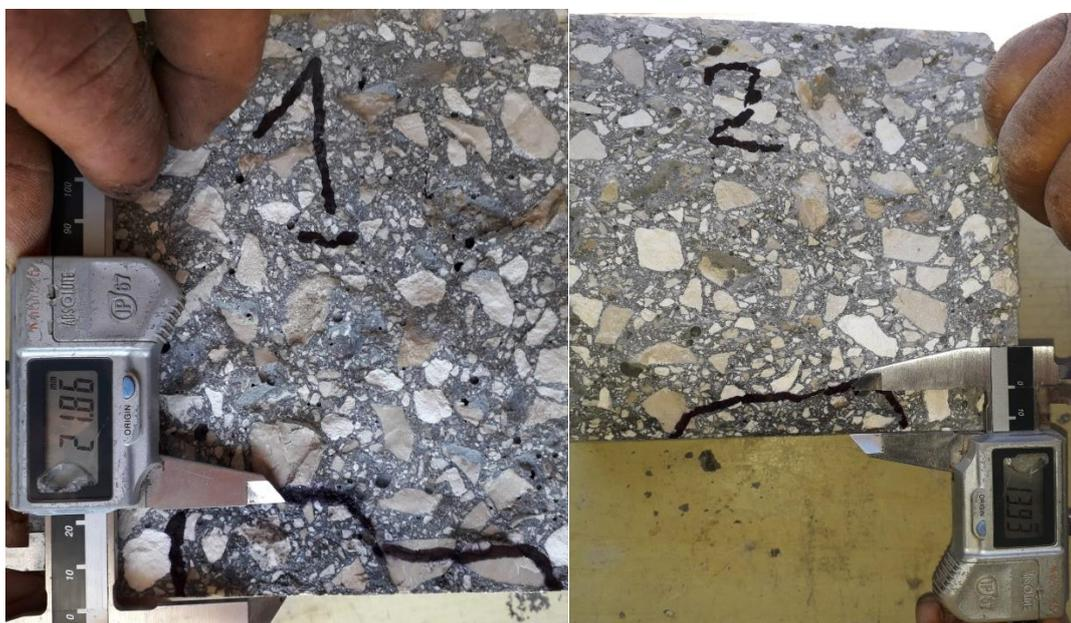
Figura 115: prova di penetrazione all'acqua – provino calcestruzzo ordinario
