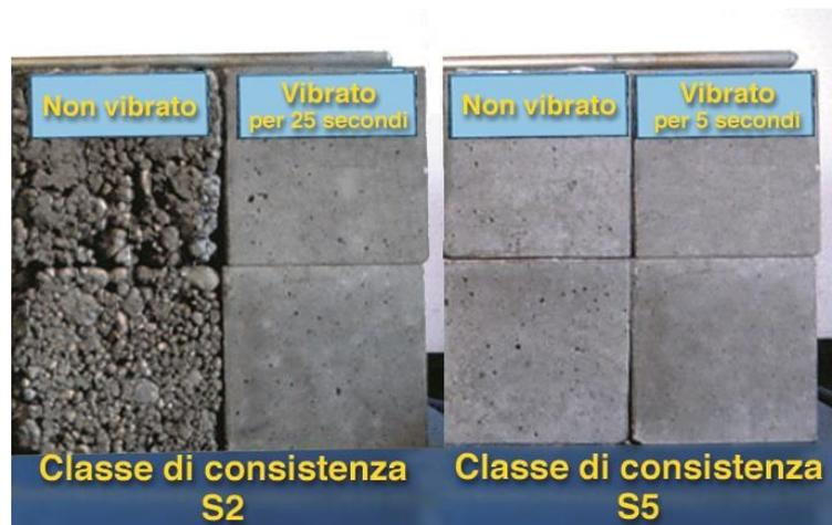
Figura 4: influenza della lavorabilità e del tempo di vibrazione sul facciavista del calcestruzzo
