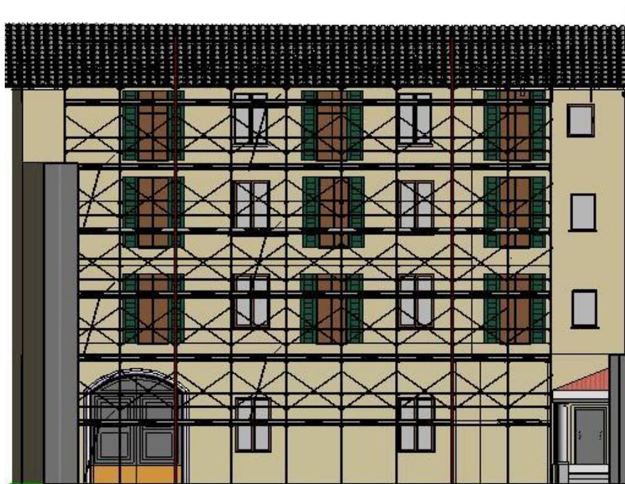
*Figura 60. Prospetto con l'inserimento del ponteggio e dei parapetti*
