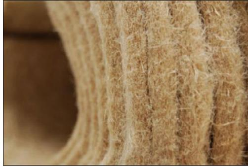
FIG 3. 2. 2. 1. 1\_ ISOLANTE ARROTOLATO IN FIBRE DI CANAPA
