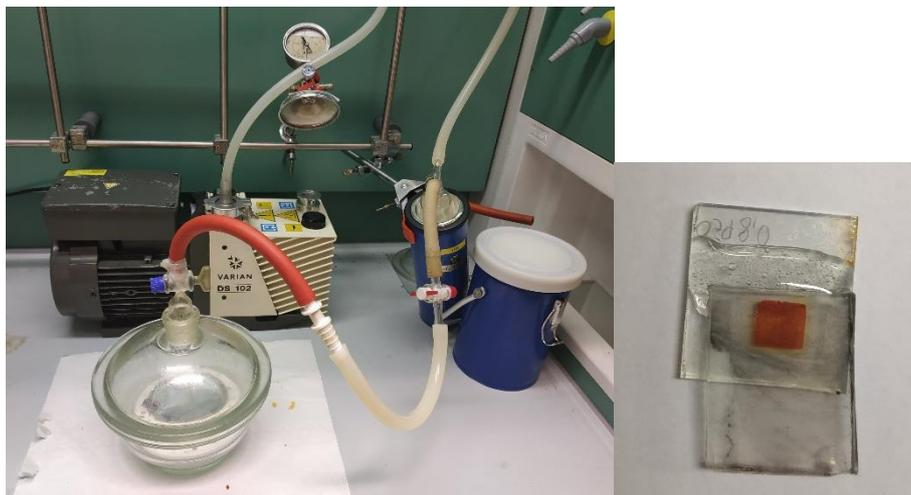
**Figura 4.12:** A sinistra la pompa da vuoto utilizzata per introdurre l'elettrolita liquido all'interno delle celle; a destra una DSSC con elettrolita liquido.
