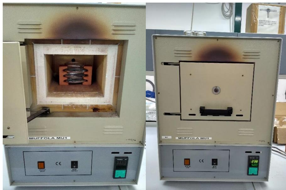
**Figura 4.5:** Riscaldamento in muffola per far avvenire il processo di sinterizzazione.
