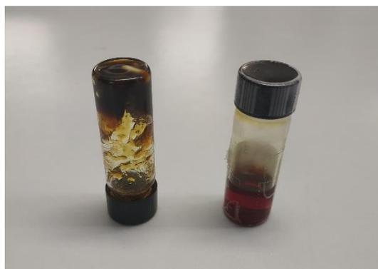
**Figura 4.9:** A sinistra l'elettrolita acquoso gel, a destra il corrispettivo in forma liquida.
