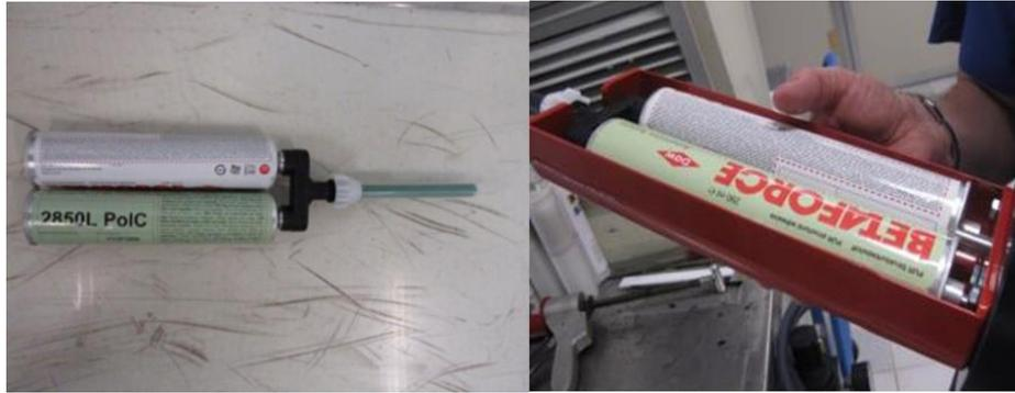
**Figura 1-24:** pistola e cartuccia di adesivo bicomponente
