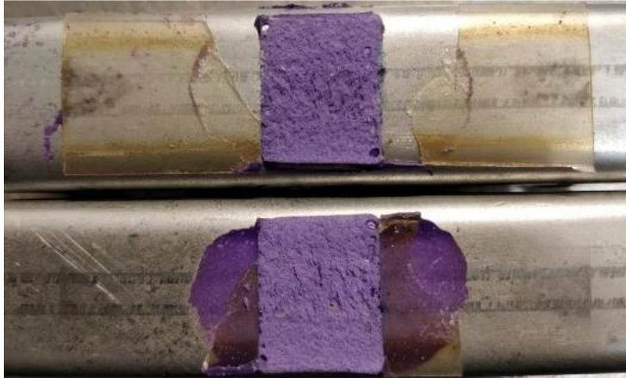
Figura 3-3: frattura coesiva
