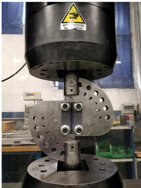
**Figura 1-37:** piastre metalliche fissate su macchina a trazione
