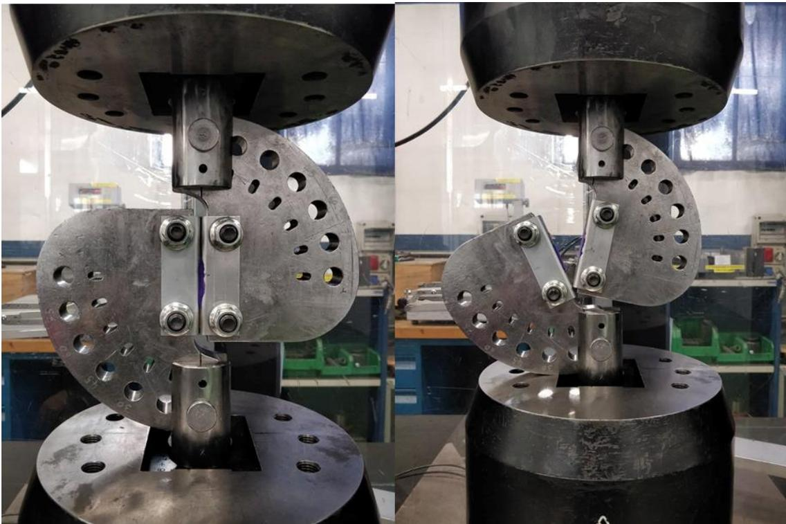
Figura 3-1: provino trazonato a 0°, prima e dopo frattura
