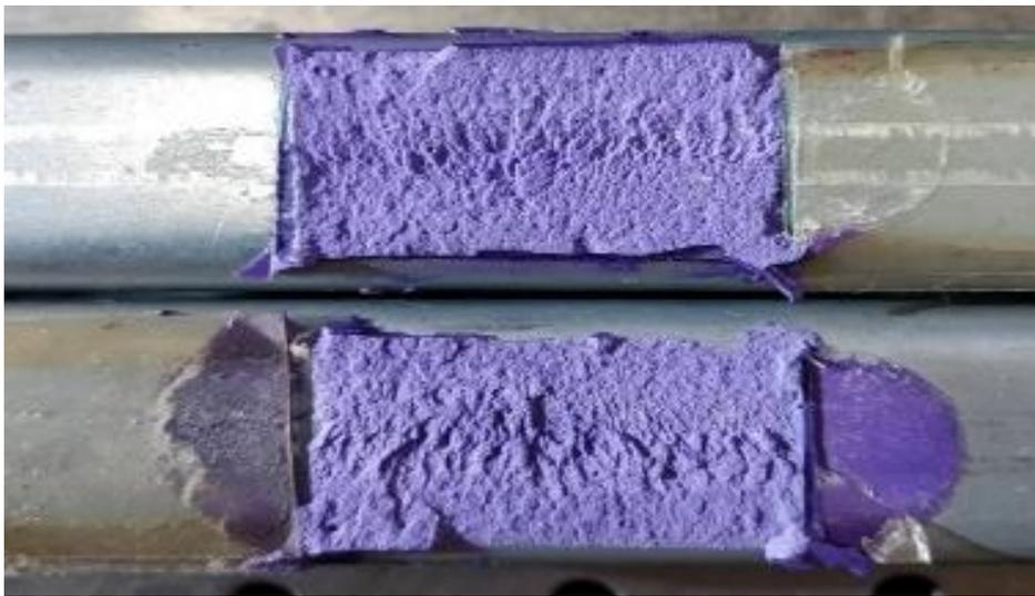
**Figura 3-27:** frattura coesiva
