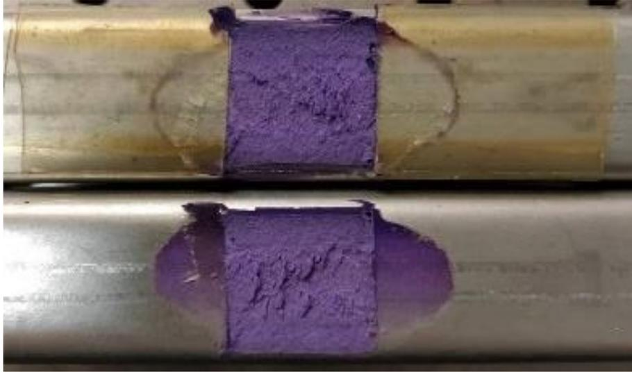
**Figura 3-5:** frattura coesiva
