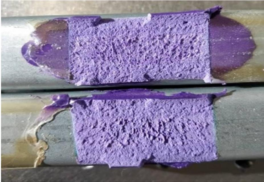
Figura 3-15: frattura coesiva
