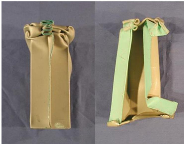
**Figura 1-34** a sinistra: provino con adesivo epossidico resistente agli urti; a destra: provino con adesivo epossidico standard; entrambi post test [4]
