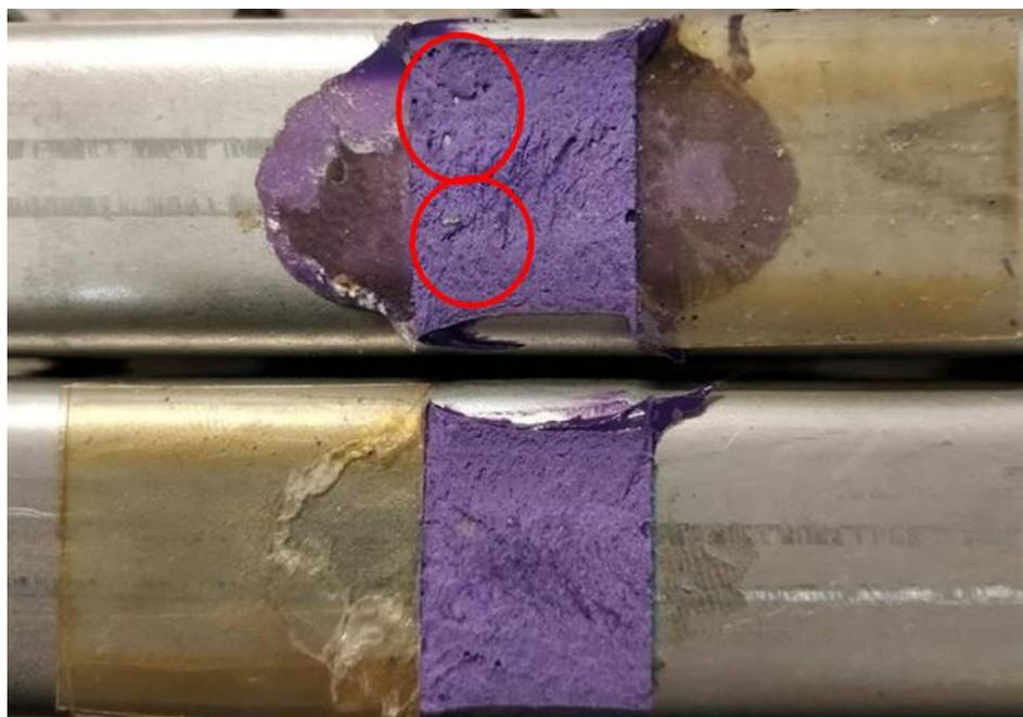
**Figura 3-10:** frattura coesiva, con focus su punti metallici
