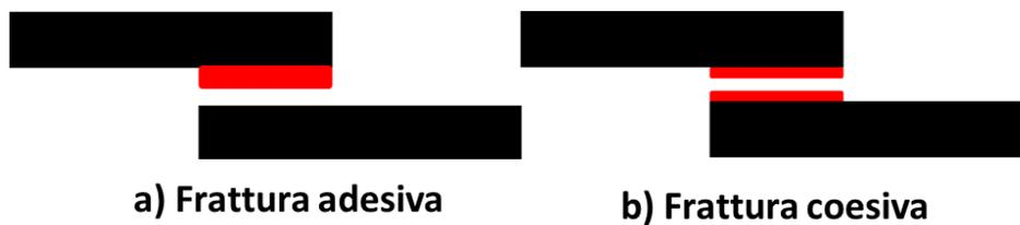
Figura 1-32: Tipologie di frattura di un giunto adesivo
