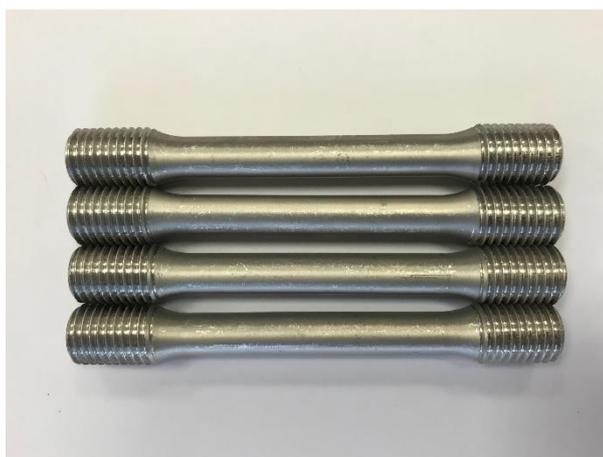
**Figura 3.4:** Provini di trazione in lega AlSi10Mg.
