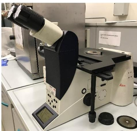
**Figura 3.7:** Microscopio ottico Leica DMI 5000.
