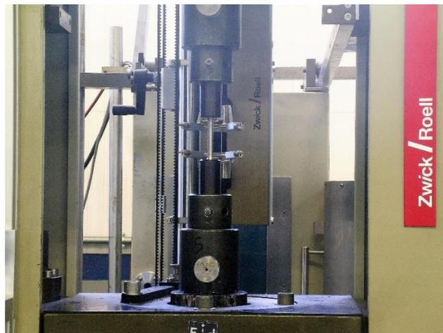
**Figura 3.13:** Macchina Zwick 1474 usata per i test di trazione.
