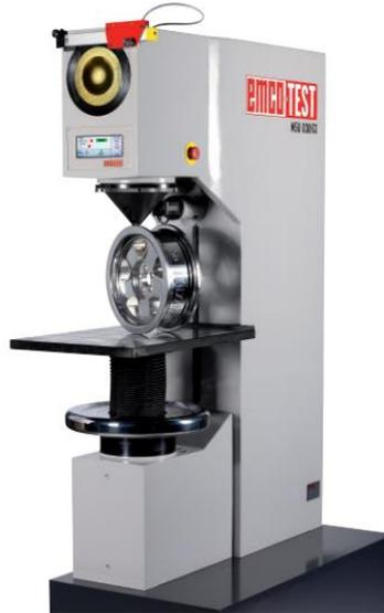
**Figura 3.11:** Durometro EMCO TEST M5U030 usato per le prove di durezza Brinell.
