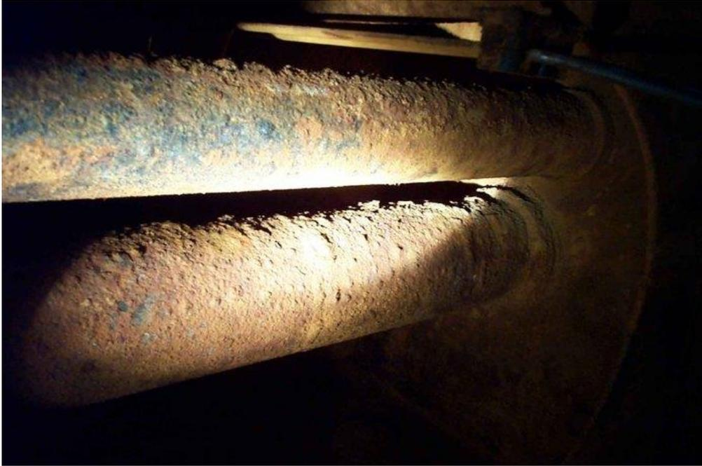
*Figura 1.2 Biocorrosione su una nave [4]*
