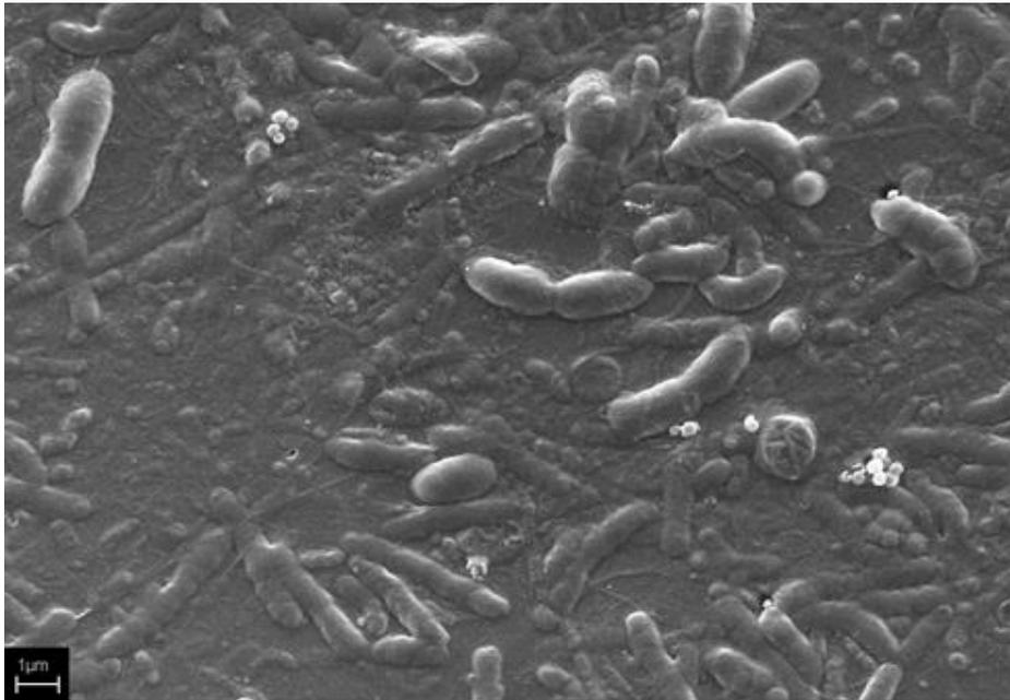
**Acciaio al carbonio con un rivestimento di resina epossidica con la minor frazione di nanoparticelle di argento**
