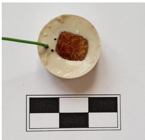
**Figura 3.14** Foto di un provino di acciaio al carbonio rivestito di resina epossidica con la maggior frazione di nanoparticelle di argento, successivamente alla prova di immersione in una cella SCMFC
