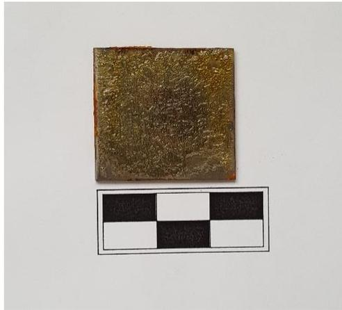
*Figura 3.12* Foto di un provino di acciaio al carbonio rivestito di resina epossidica con la maggior frazione di nanoparticelle di argento, dopo 360 ore di immersione in una soluzione aerata 0,1 M di cloruro di sodio
