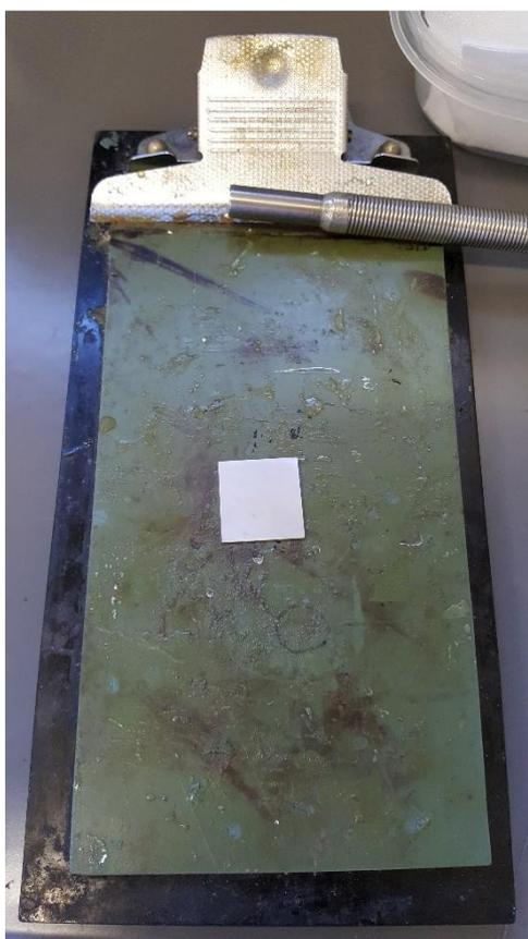
*Figura 2.4* Rivestimento di un campione di acciaio al carbonio con una barra stendifilm
