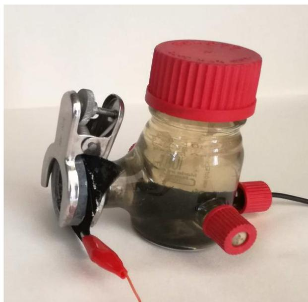
*Figura 2.17* Foto di una Single Chamber Microbial Fuel Cells [16]
