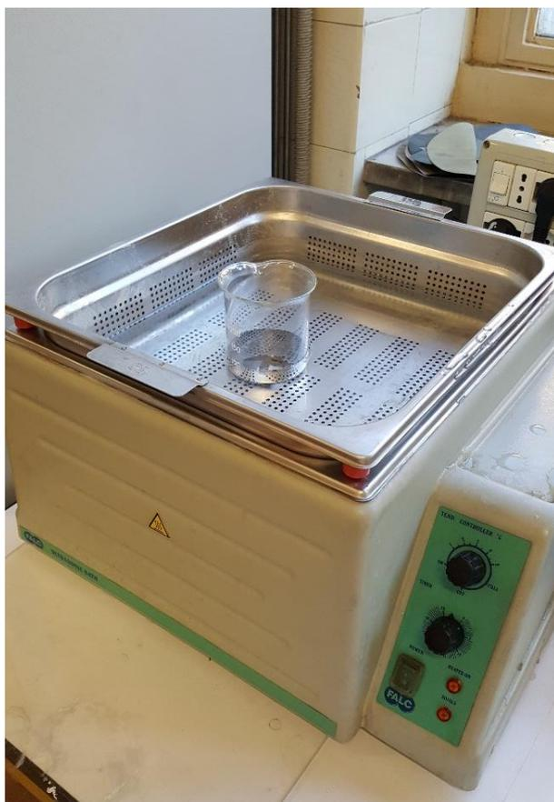
*Figura 2.1* Campioni di acciaio al carbonio durante la pulitura a ultrasuoni con etanolo
