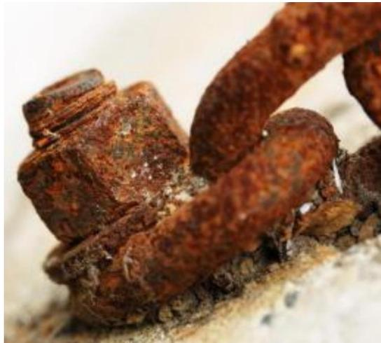
*Figura 1.1* Ossidazione del ferro per azione dell'acqua (ruggine)
