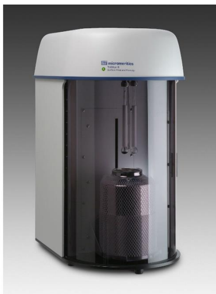
Figura 3.4: Micromeritics Tristar II, apparecchiatura utilizzata per le analisi BET.
