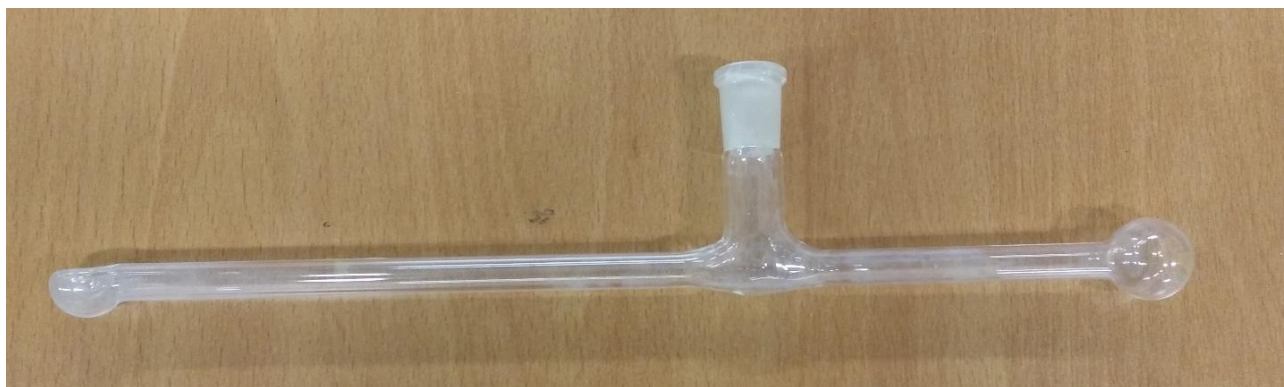
Figura 3.2: Reattore a due bulbi utilizzato per la sintesi del campione sublimato.
