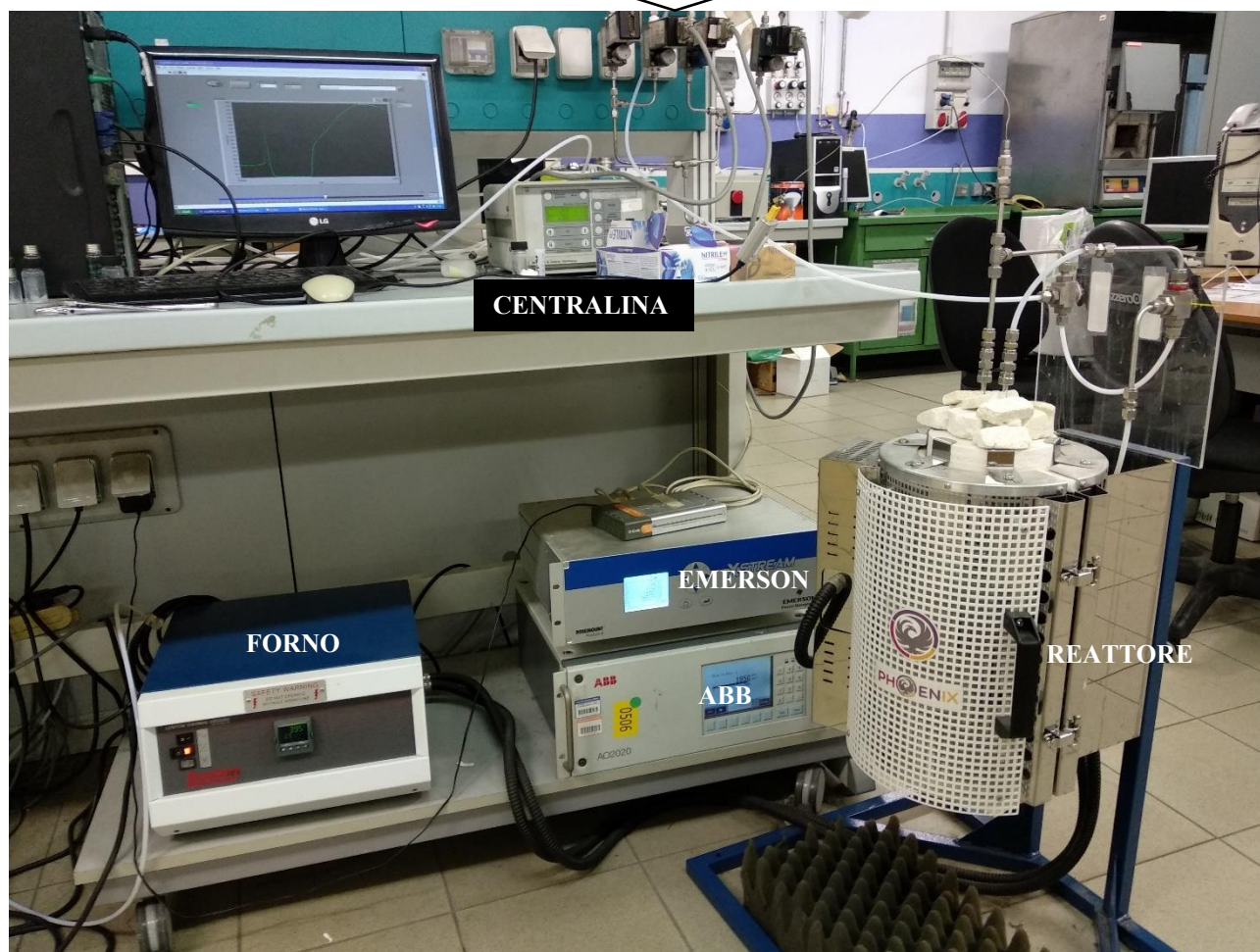
Figura 3.1: In alto: schema dell'apparato strumentale utilizzato per la conduzione dei test catalitici; in basso: fotografia dell'impianto.
