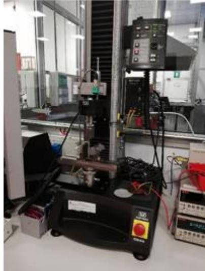
*Figura 6.7* Dinamometro Instron 5544.
