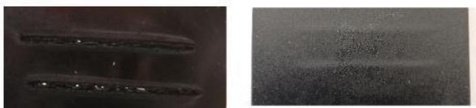
**Figura 9.95** Immagini reali di a) provino perforato dal trattamento laser; b) segni del trattamento laser sulla superficie del provino opposta a quella trattata.
