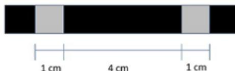
**Figura 6.4** Schematizzazione della realizzazione degli elettrodi (aree grigie) su una barretta.
