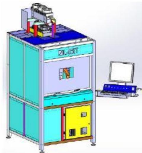
**Figura 6.12** Immagine del laser CO<sub>2</sub> modello Towermark XL.
