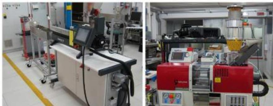
*Figura 6.1* A sinistra estrusore bivite Thermo Haake Eurolab 16 (16/25), a destra pressa Babyplast 6/10P.
