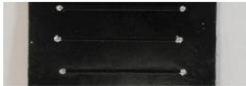
*Figura 6.6 Elettrodi realizzati sulle tracce laser al fine di misurare la resistenza elettrica.*
