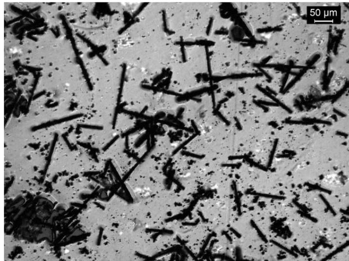
**Figura 4.63** Ingrandimento 100x delle fibre di carbonio presenti nel Carbon PA.
