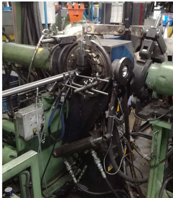
**Figura 1.12:** immagine di una testa matrice di co-estrusione.
