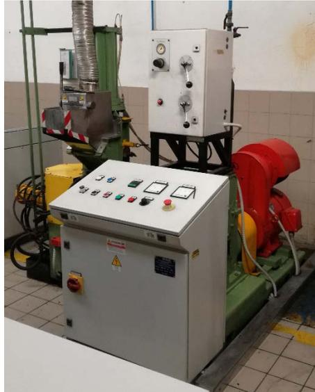
**Figura 4.2:** apparato strumentale per un miscelatore in scala 1:10 (mini-Brandbury).
