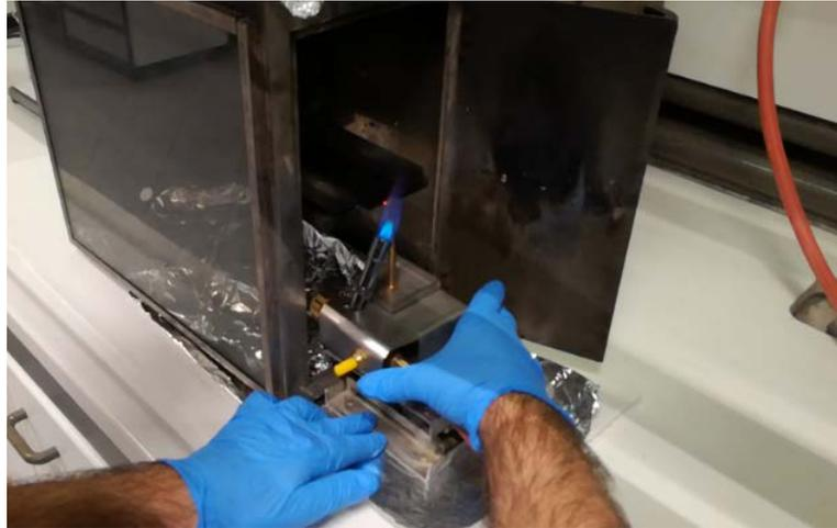
**Figura 4.8:** immagine rappresentativa dell'apparato strumentale utilizzato per il testo di combustione orizzontale.
