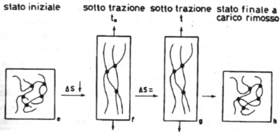
**Figura 1.3:** stati caratteristici di deformazione elastica di un elastomero vulcanizzato e  $\Delta S$  associato.
