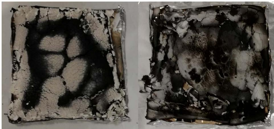
**Figura 6.8:** residuo del provino ottenuto dal test al cono calorimetro delle mescole a) EHP71 e b) V-KU 70-00 (V.03).
