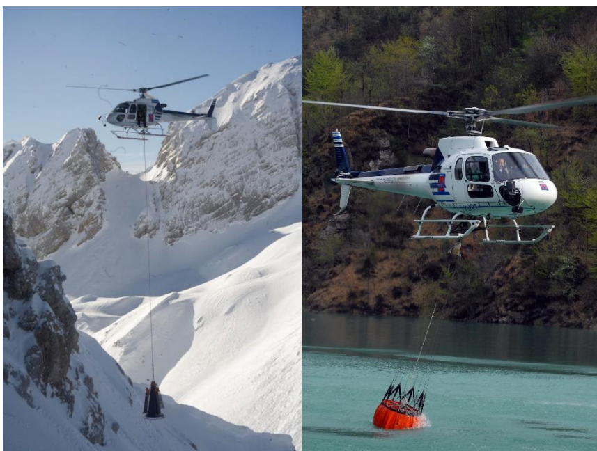
Figura 17 Attività di lavoro aereo al gancio baricentrico e antincendio svolta con gli elicotteri AS350B3
