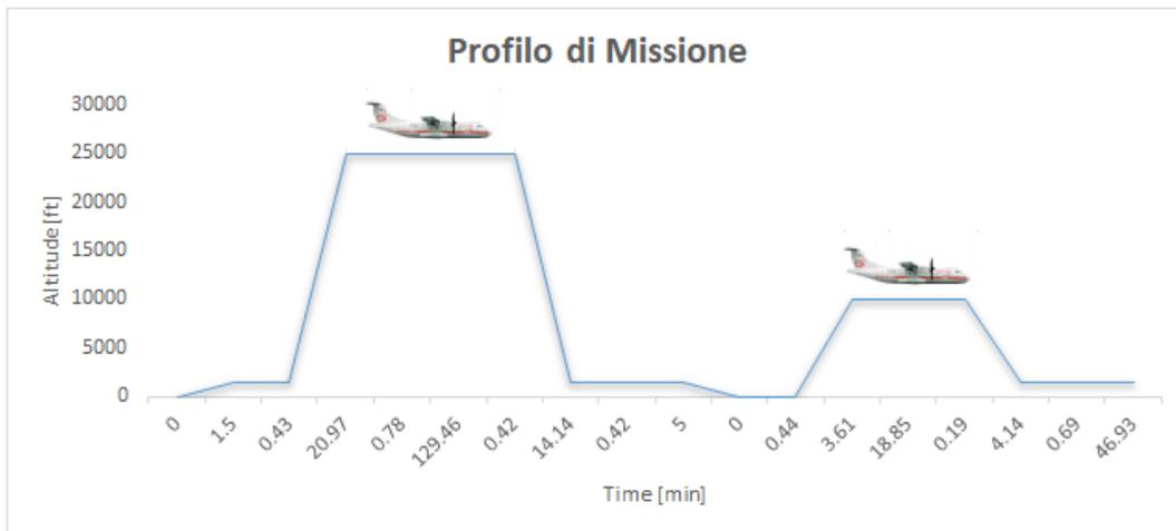
la figura rappresenta il profilo di missione del velivolo progettato; bisogna distinguere, fondamentalmente, tre differenti sotto-fasi di missione: 800 nm seguiti da 100 nm per raggiungere l'aeroporto alternato e 30 min di attesa.
