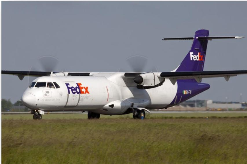
è un aereo di linea regionale bimotores turboelica, impiegato per il trasporto di passeggeri su tratte di corto raggio. Come tutti i turboelica è caratterizzato da forte accelerazione in fase di decollo, bassi consumi e possibilità di partire anche da piste corte, tuttavia volando ad altitudini di crociera più basse rispetto ai jet, è più sensibile alle turbolenze atmosferiche.
