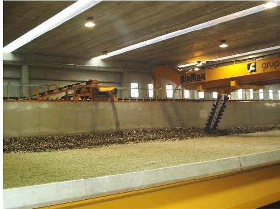
*Figura 18 Rivoltamenti della miscela organica utili per facilitare la biossidazione (compostaggio)*
