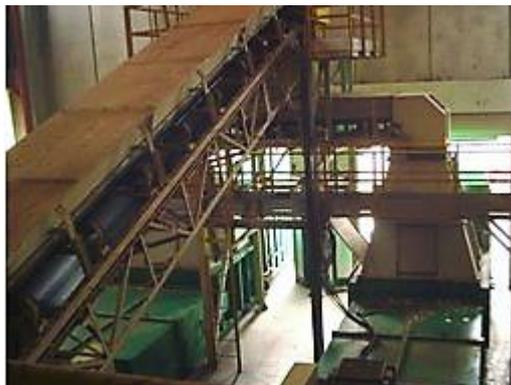
Figura 14 Trituratore secondario (RSU)
