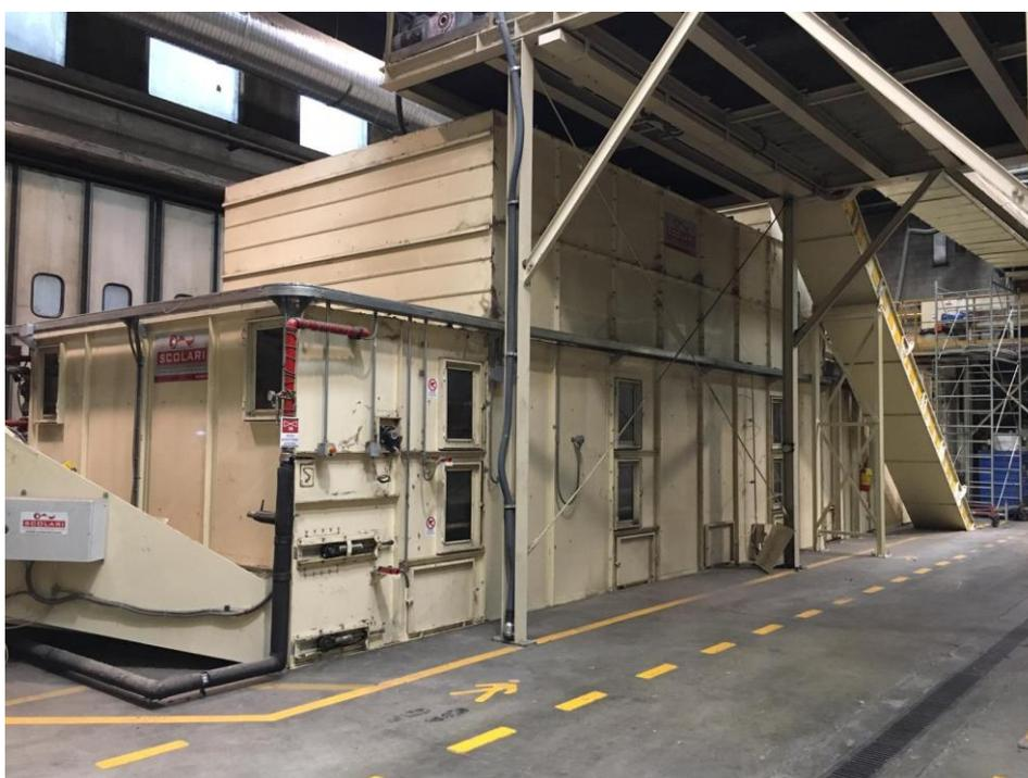
*Figura 34 Essiccatoio a tappeti utilizzato dall'A.C.S.R. di Roccavione*
