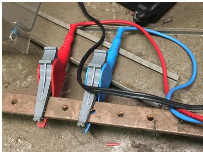
*Figura 41 Messa a terra dello strumento per il monitoraggio dei ventilatori*
