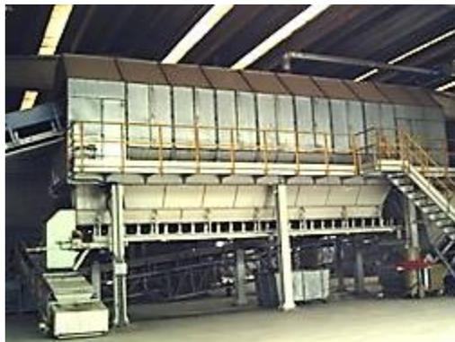
Figura 13 Vaglio per la vagliatura dei RSU
