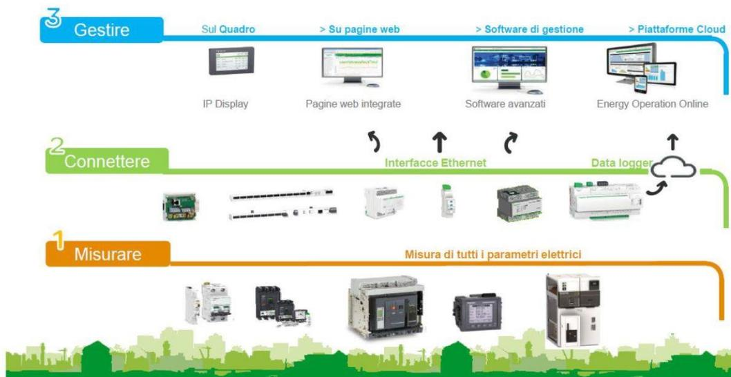
**Figura 1: struttura di un sistema per la gestione energetica**
