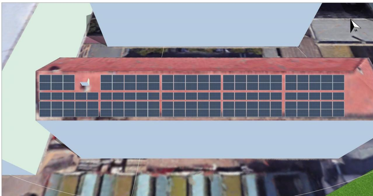
Figura: 1. Superficie moduli - Tetto1-Superficie tetto sud-ovest
