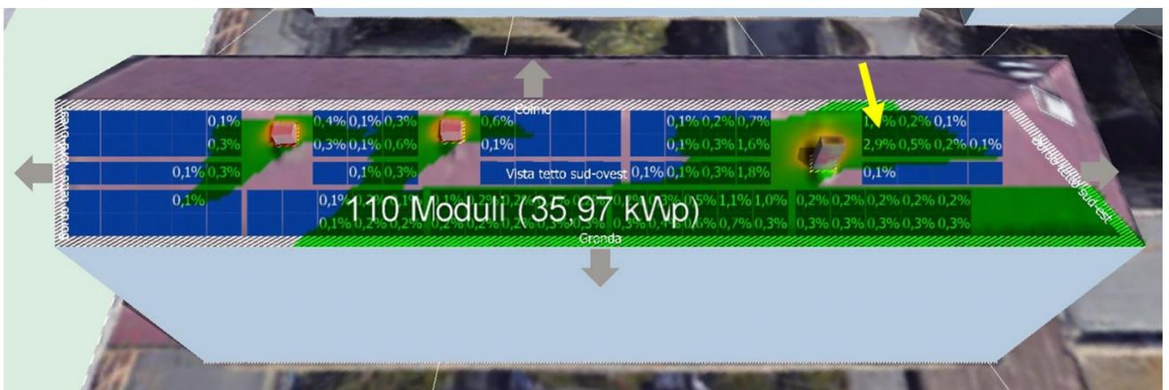
Figura 65. Simulazione di ombreggiamento per la falda dell'Edificio 2, Configurazione B
