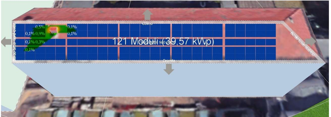
Figura 64. Simulazione di ombreggiamento per la falda dell'Edificio 1, Configurazione B
