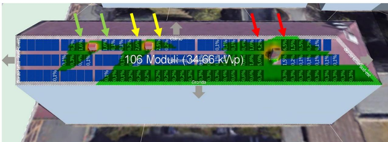
Figura 63. Simulazione di ombreggiamento per la falda dell'Edificio 2, Configurazione A
