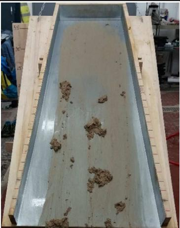
**35°:** rimane ancora una piccola percentuale di fine sullo scivolo. Al diminuire della schiuma si nota una riduzione della collosità del fine e la tendenza ad aderire allo scivolo.
