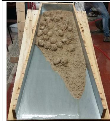
**20°:** Già a 20° il materiale fluisce velocemente sullo scivolo, parte del fine si separa dalla massa.
