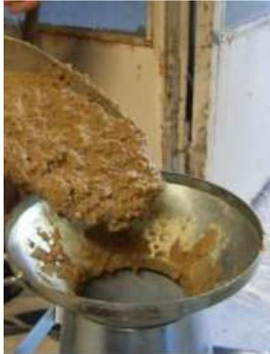
*Figura 10: Immissione del materiale condizionato nel cono di Abrams*
