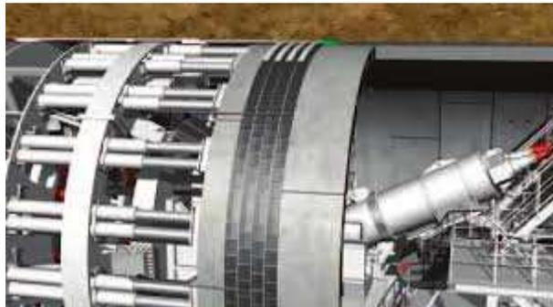
*Figura 6: Cilindri di spinta © Herrenknecht AG*
