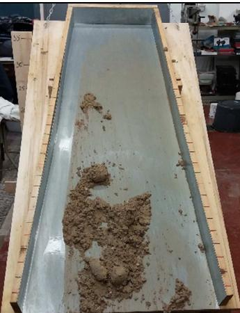
**35°:** Tra 30° e 35° si sviluppa un cinematismo che porta gran parte del blocco di materiale in vasca. La restante parte rimasta sullo scivolo, dimostra una buona capacità del fine di trattenere i ciottoli anche a 35°
