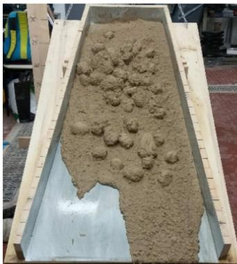
**25°:** Iniziano ad arrivare in vasca di raccolta alcuni ciottoli e una piccola parte di fine; la matrice non è in grado di trattenere in maniera ottimale i ciottoli che tendono a scorrervi sopra.
