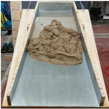
**20°:** Il fine e i ciottoli si muovono in maniera abbastanza uniforme, l'insieme esibisce un movimento plastico. Si nota una leggera mancanza di schiuma in quanto il materiale risulta concentrato in una piccola porzione di scivolo.
