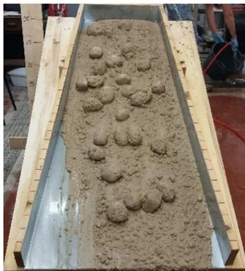
**25°:** il movimento del materiale avviene in maniera uniforme, con i ciottoli che vengono trattenuti dalla matrice fine.
