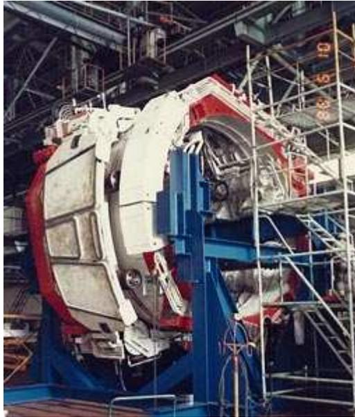
*Figura 5: Erettore dei conchi prefabbricati © [www.terratec.com](http://www.terratec.com)*
