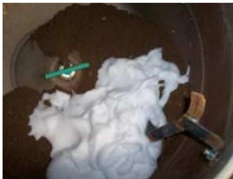
Figura 9: Miscelazione del materiale in betoniera
