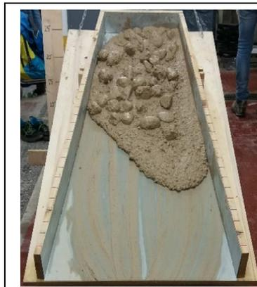
**20°:** Il materiale fluisce sullo scivolo; si nota una parte di fine che tende a separarsi e a fluire più velocemente rispetto ai ciottoli.
