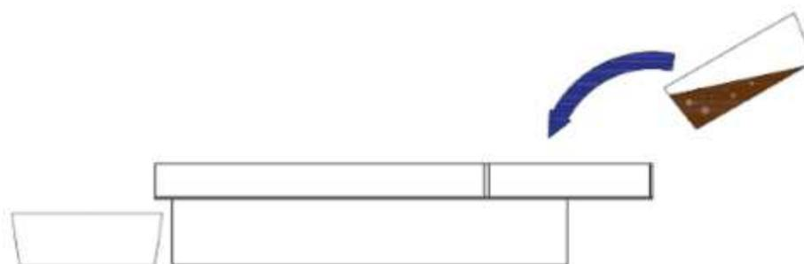
*Figura 20: Introduzione del campione nell'alloggiamento in testa allo scivolo (Carigi,2017)*
