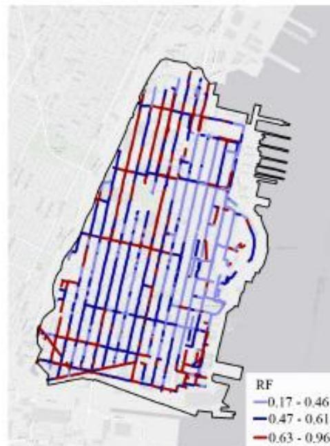
Figura 2-6: mappa della probabilità di danni strutturale della rete fognaria , con RF 'Risk of Failure' si indica la probabilità di danneggiamento [13]
