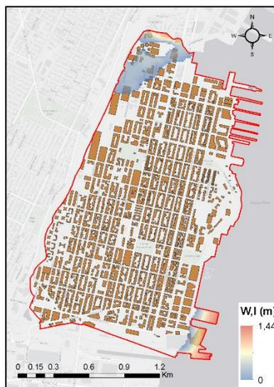
Figura 4-15.: aree soggette ad allagamento, considerando il livello massimo del fiume; con  $W,l(m)$  viene indicato il livello idrico al di sopra del piano campagna riferito al datum NAVD88
