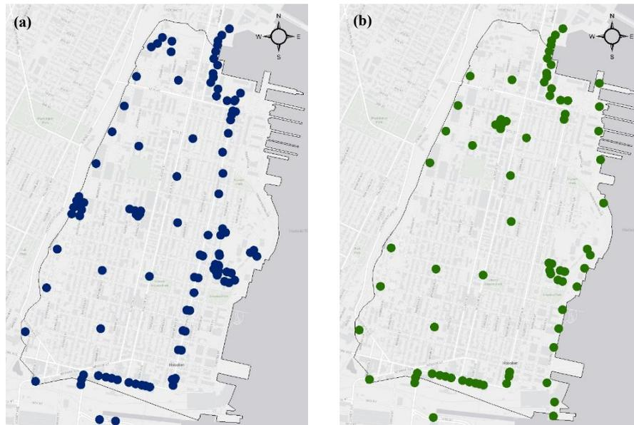
Figura 4-9: (a) sondaggi che individuano la profondità del bottom dello strato di copertura, (b) sondaggi che individuano la profondità del top del basamento roccioso
