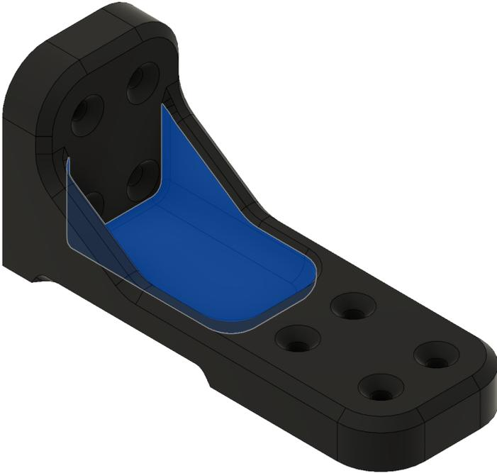
Lo scasso presente nella parte centrale del componente svolge, in maniera simile a quanto visto per il *Bracket*, la duplice funzione di irrigidire la struttura consentendo allo stesso tempo il passaggio degli strumenti necessari al serraggio delle viti. Da non dimenticare è il risparmio di materiale che comporta questa particolare scelta progettuale.
