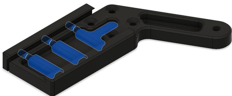
All'interno della cavità sono presenti i rinforzi per le sedi delle viti di serraggio della morsa ARCA.
