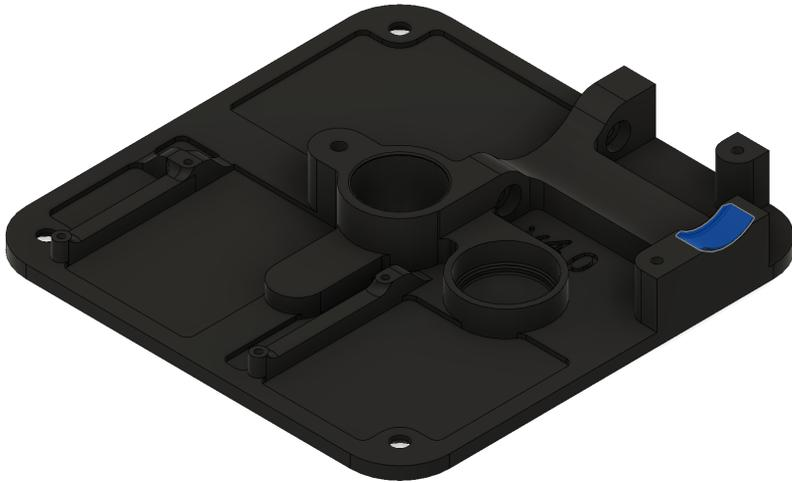
In linea con il dettaglio appena scritto è presente l'alloggiamento per il cuscinetto a sfera utilizzato per l'asse del motore passo passo. L'alloggiamento presente sulla *Base* richiede l'installazione del *Bracket* per poter serrare il cuscinetto.
