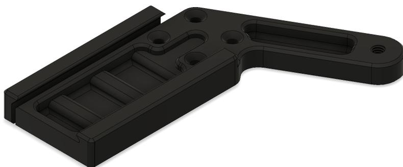
Per consentire l'installazione della fotocamera necessaria alla cattura delle fotografie ad alta gamma dinamica, si deve utilizzare l'appositamente progettato *Camera Bracket*, da installare sul *Piatto Rotante* dell'unità verticale.
