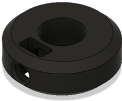
Ad assicurare la solidità del sistema, si è progettato un blocco da porre sullo stesso asse del *Piatto Rotante*, una volta bloccato serrando il grano, risulta impossibile rimuovere il *Piatto*, scongiurando la caduta dell'equipaggiamento installato su di esso.
