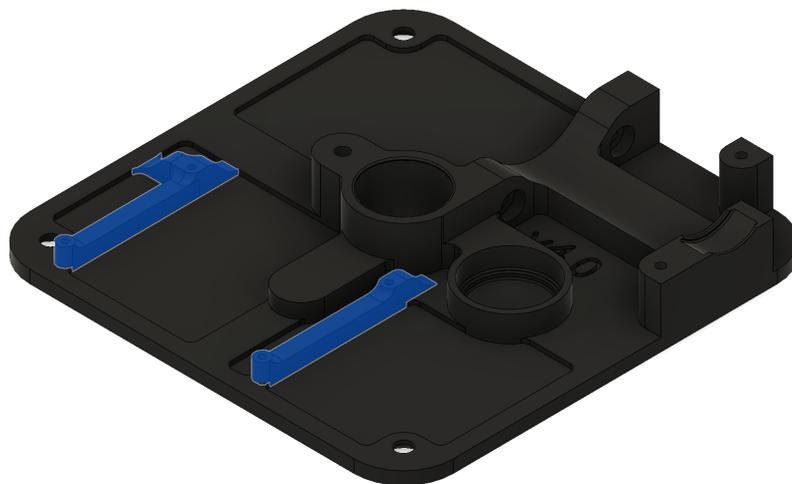
Se la parte posteriore dell'oggetto è stata dedicata all'alloggiamento dei componenti meccanici, nella sezione anteriore si colloca l'elettronica: sono infatti presenti i punti di ancoraggio della PCB.
