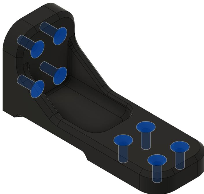
Il componente si interfaccia con le due unità attraverso gli appositi fori predisposti sui lati della *Cover*.
