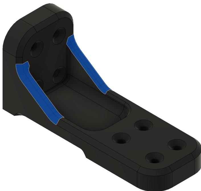
Per ridurre la torsione della staffa sotto sforzo, due intensi raccordi sono stati realizzati tra i due piani del componente.
