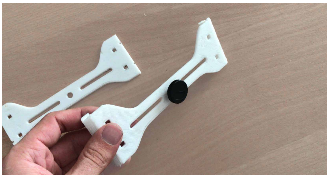
Fig. 211. Realizzazione prototipo di supporto tramite stampa 3d
