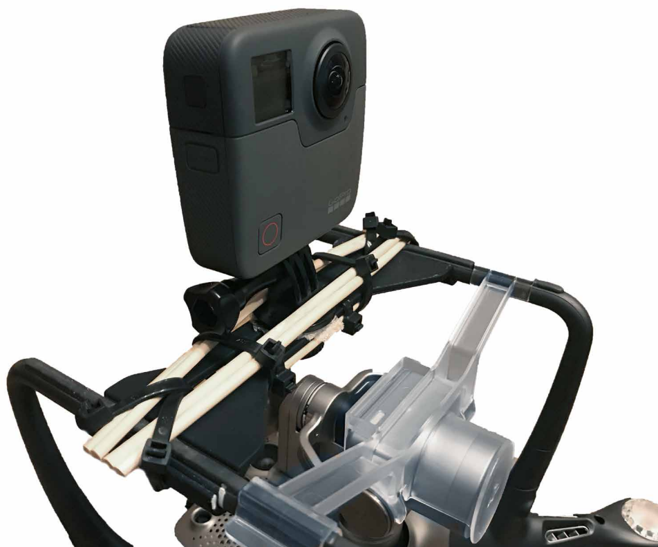
Fig. 223. Prototipo ultimato in laboratorio per la connessione Camera/Uav .
