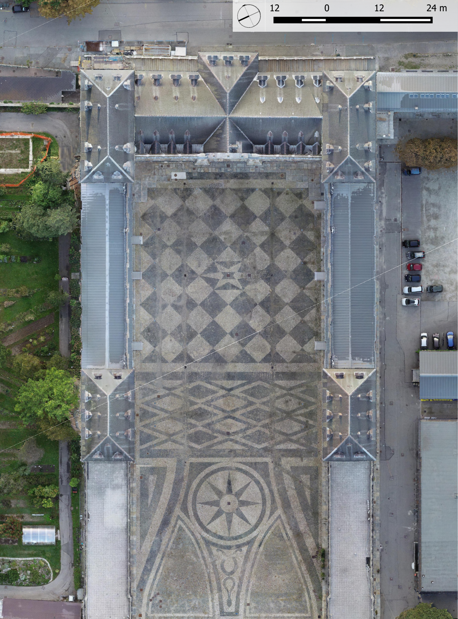
Fig. 327. Torino, Castello del Valentino , Ortofoto Dettaglio Cortile (fuori scala); Realizzata attraverso l'integrazione delle immagini frame (nadirali+inclinate) e i panorami sferici acquisite da UAV.
