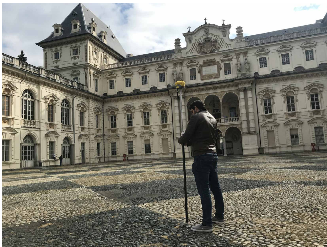
Fig. 284. Acquisizione di punti naturali attraverso rilievo topografico satellitare NRTK.
