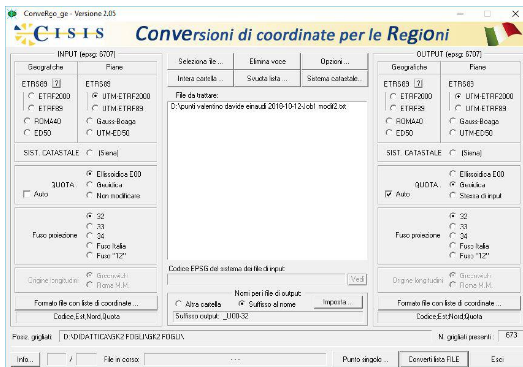
Fig. 243. Settaggi utilizzati per la proiezione delle coordinate da ellissoidiche a geoidiche attraverso ConveRgo_ge alla versione 2.05.
