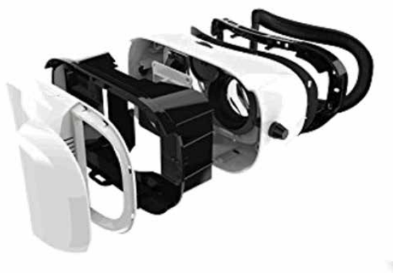
Fig. 400. Esploso di un visore 3D low cost . [fonte: https://yammo.store/prodotto/vr-box-joypad-bluetooth/ ]
