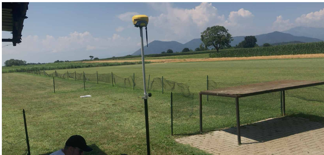
Fig. 240. Acquisizione coordinate dei target topografici attraverso tecnologia NRTK .
