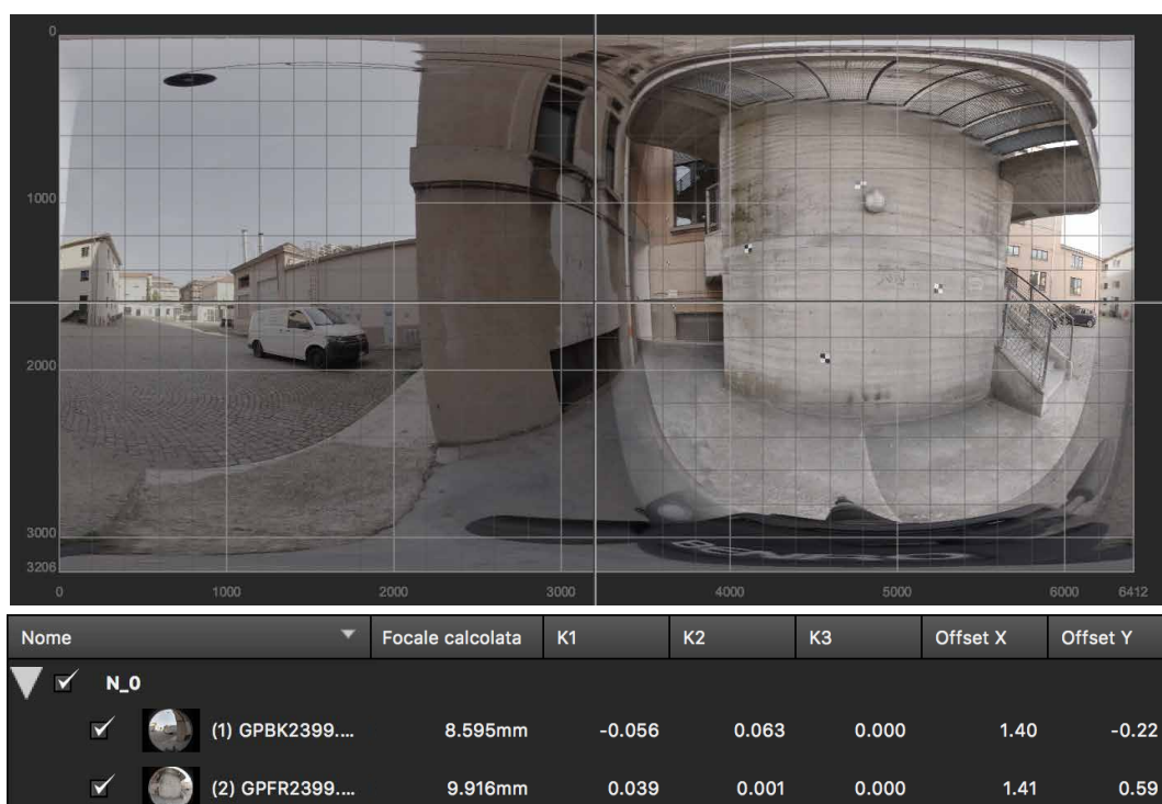
Fig. 182. Nella figura sono mostrati il risultato delle unioni delle immagini dopo la correzione degli exif e a seguito del processo di ottimizzazione eseguito sui risultati della figura precedente. Si possono osservare miglioramenti significativi nello stitching delle immagini oltre che l'eliminazione dei valori outliers dei parametri di orientamento interno.
