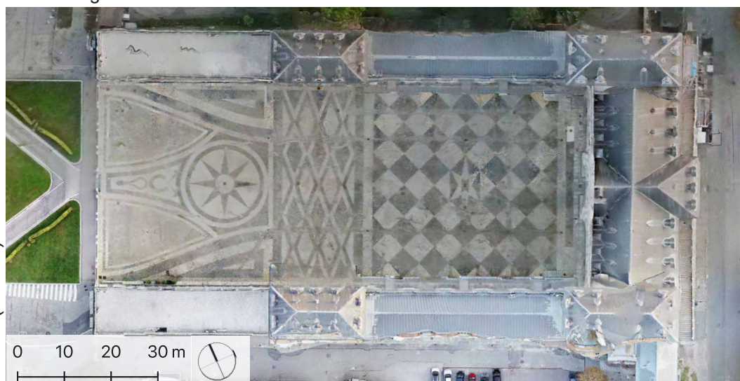
Fig. 305. Torino, Castello del Valentino , ortofoto del modello generato dalle immagini nadirali e dalle immagini sferiche utilizzando entrambe per la realizzazione dell'ortofoto.
