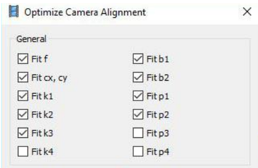
Fig. 88. Schermata relativa alla scelta dei parametri oggetto della procedura automatizzata di ottimizzazione.
