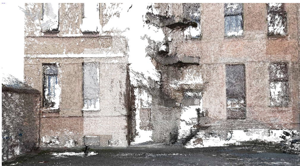
Fig. 191. Ricostruzioni fotogrammetriche attraverso l'utilizzo di panorami sferici in numero decrescente e valutazione sulla qualità delle nuvole di punti restituite. In alto la nuvola di punti generata da 53 immagini, in centro da 17 e in basso da 12.
