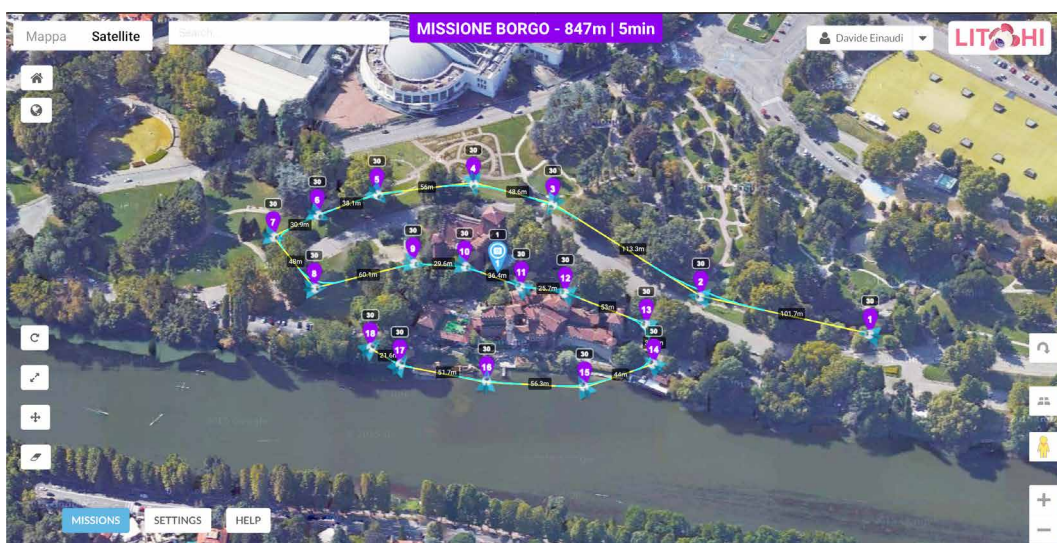
Fig. 425. Torino, Borgo Medievale , pianificazione dei voli automatici attraverso il Mission Hub di LitchiApp per l'acquisizione di filmati 360°
