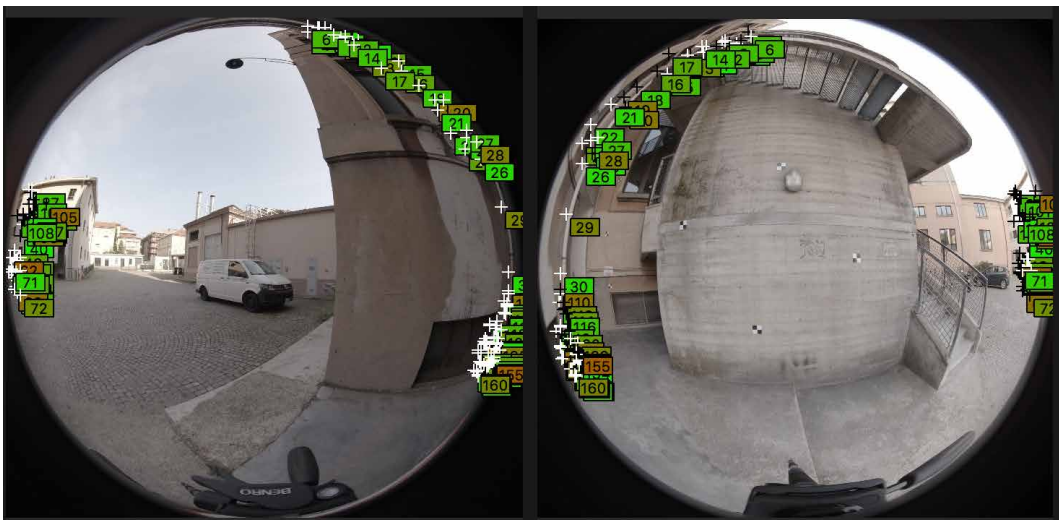
Fig. 174. In figura i punti omologhi riconosciuti tra le immagini aggiunti tramite la procedura semi-automatizzata di riconoscimento tramite analisi geometrica.
