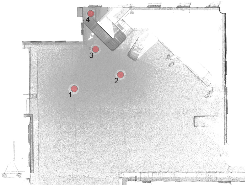
Fig. 123. Posizione delle scansioni laser scanner terrestre eseguite tramite FARO Focus3d x330 sull'area di test.
