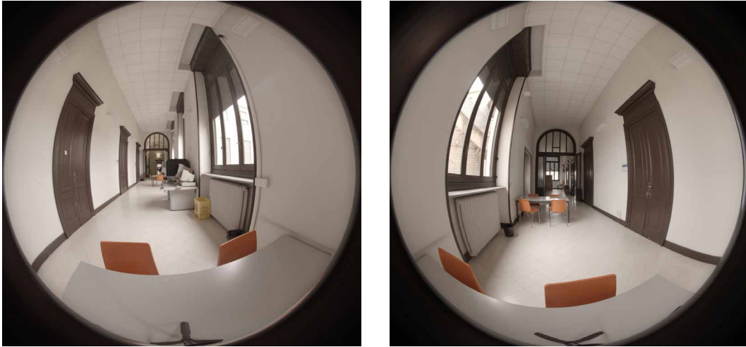
Fig. 164. Immagini scattate simultaneamente dalle due camere prima del processo di stitching .
