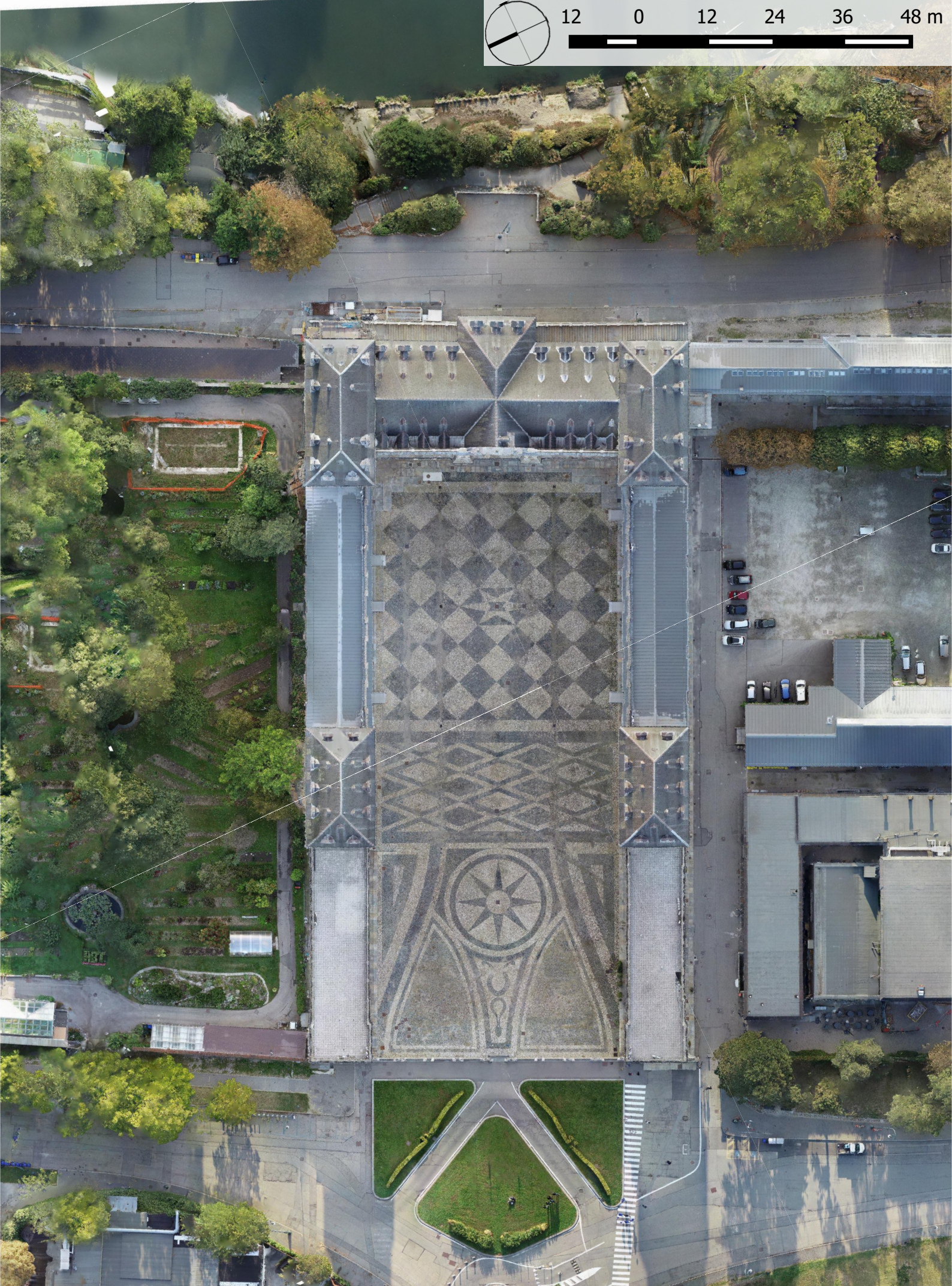
Fig. 326. Torino, Castello del Valentino , Ortofoto Generale (fuori scala); Realizzata attraverso l'integrazione delle immagini frame (nadirali+inclinate) e i panorami sferici acquisite da UAV.
