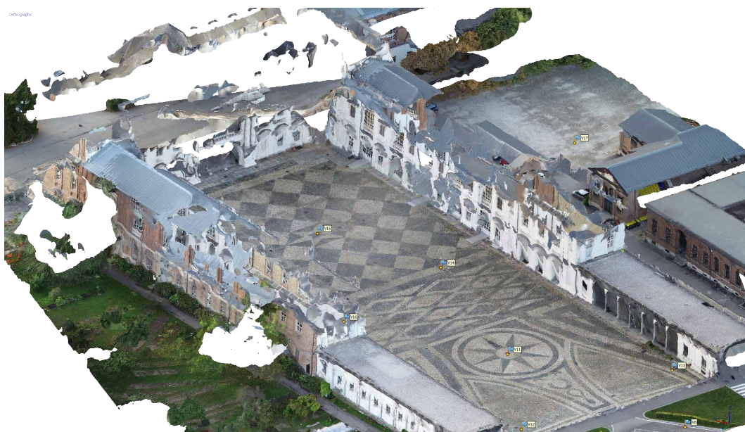
Fig. 288. Visualizzazione assonometrica della nuvola di punti dalla quale appaiono evidenti le problematiche di ricostruzione degli alzati attraverso il solo uso di immagini nadirali.
