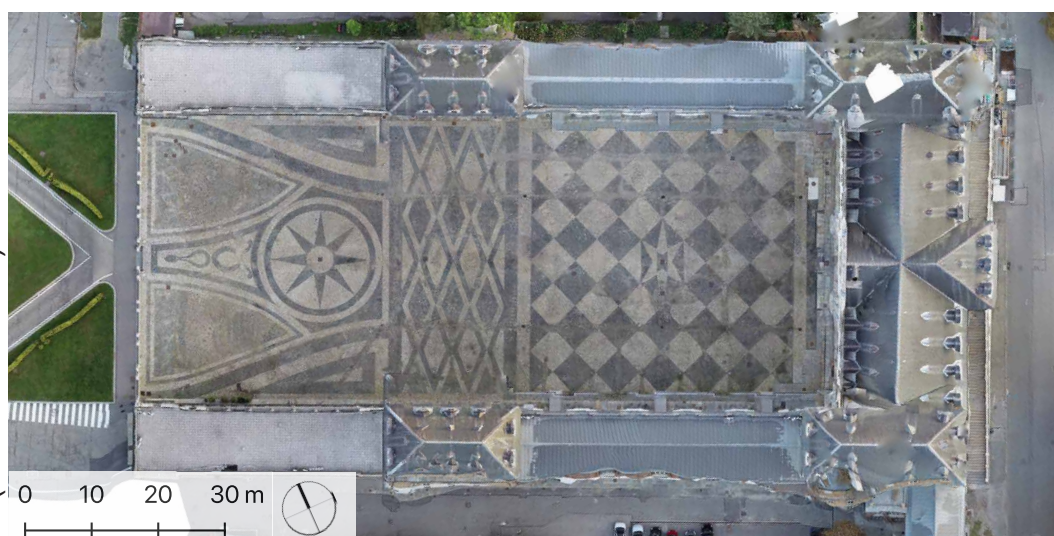
Fig. 306. Torino, Castello del Valentino , ortofoto del modello generato dalle immagini nadirali e dalle immagini sferiche utilizzando solo le nadirali per la realizzazione dell'ortofoto.
