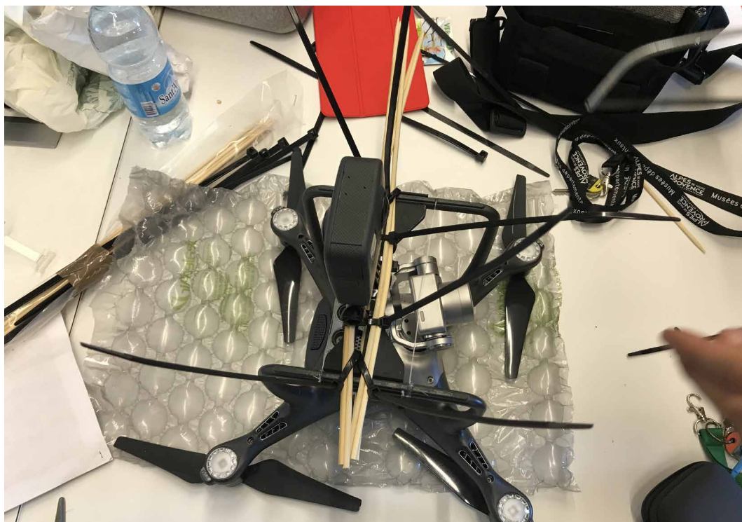
Fig. 221. Assemblaggio del prototipo di connessione Camera/Uav in laboratorio.
