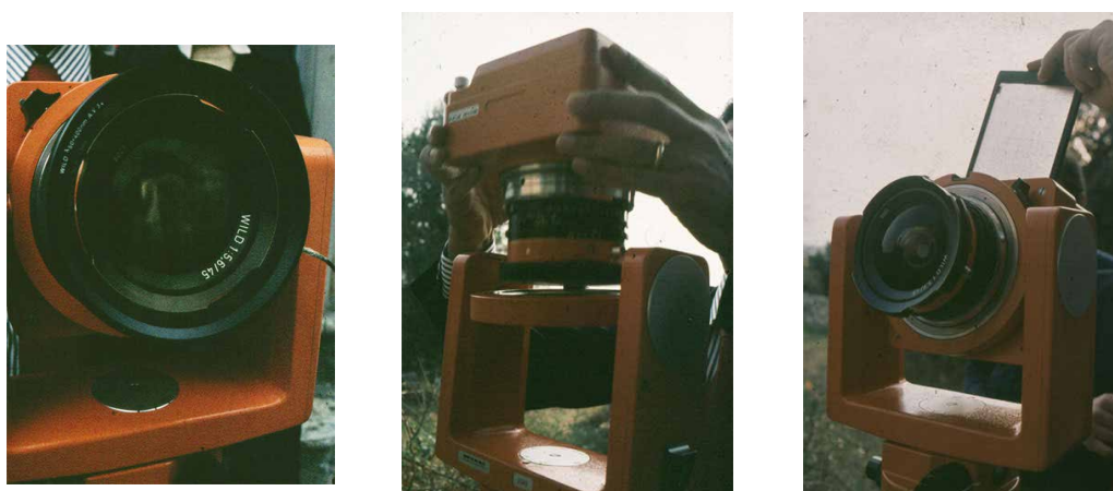
Fig. 8. Esempio di camera metrica terrestre modello WILD P32 . Il formato utile dell'immagini acquisita dalla camera è pari a 10 x 13 cm.
