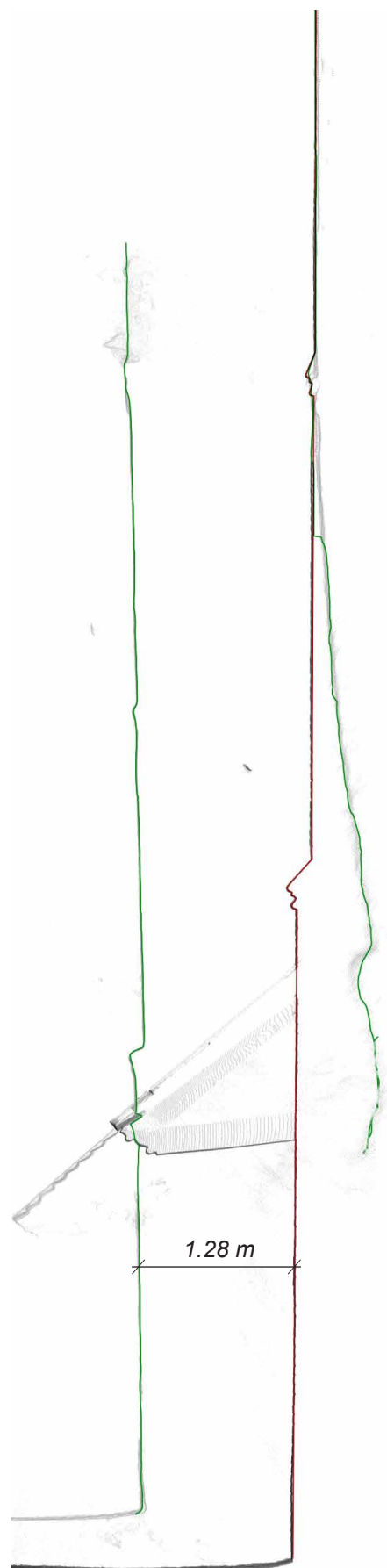
Fig. 373. Sezione trasversale di sovrapposizione delle nuvole di punti lidar e fotogrammetrica nelle aree critiche della ricostruzione dalla quale si può osservare lo sdoppiamento della geometria per la nuvola generata attraverso l'uso dei quattro panorami sferici.
