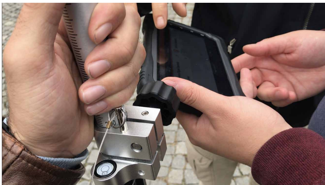
Fig. 28. Connessione del ricevitore satellitare topografico alla rete delle stazioni permanenti attraverso l'uso della connessione di rete.
