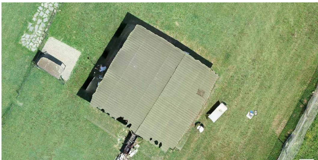
Fig. 261. Ortomosaico realizzato attraverso l'uso delle sferiche per l'orientamento delle inclinate.
