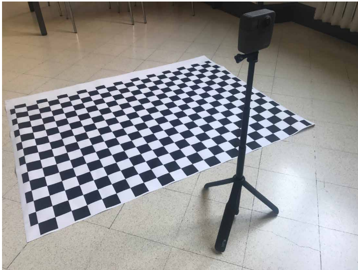
Fig. 73. Target chessboard realizzato per la calibrazione con il tool Lens di Agisoft Photoscan
