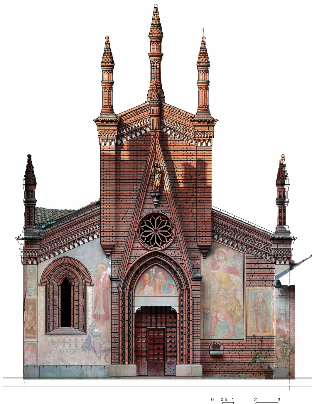
Fig. 380. Ortofoto Chiesa Borgo Medievale, Torino, scala 1:100. L'immagine è stata generata dall'integrazione di single frame e immagini sferiche.
