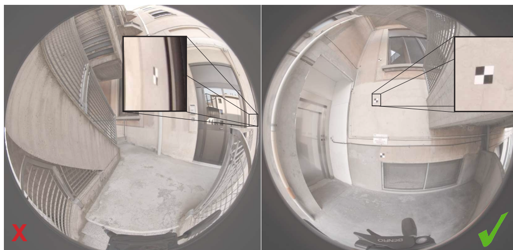
Fig. 195. A sinistra la posizione di un target che non è consigliato inserire in quanto posto in una zona troppo affetta da distorsione dell'immagine. A destra la posizione migliore in cui fissare la posizione del target .
