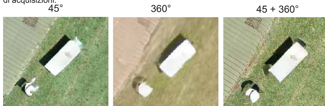
Fig. 255. Comparazione di un area di dettaglio sull'ortomosaico con le diverse tipologie di acquisizioni.
