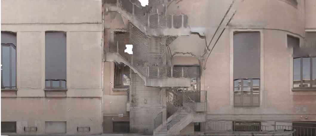
Fig. 116. Porzione di ortofoto di ricostruzione eseguita attraverso la Camera Back .
