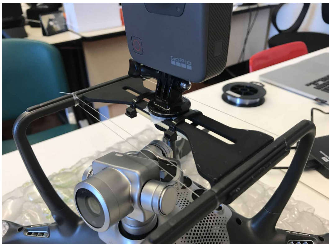
Fig. 201. Primi studi e applicazioni dei sistemi di ancoraggio tra il Dji Phantom 4 Pro Obsidian e GoPro Fusion .
