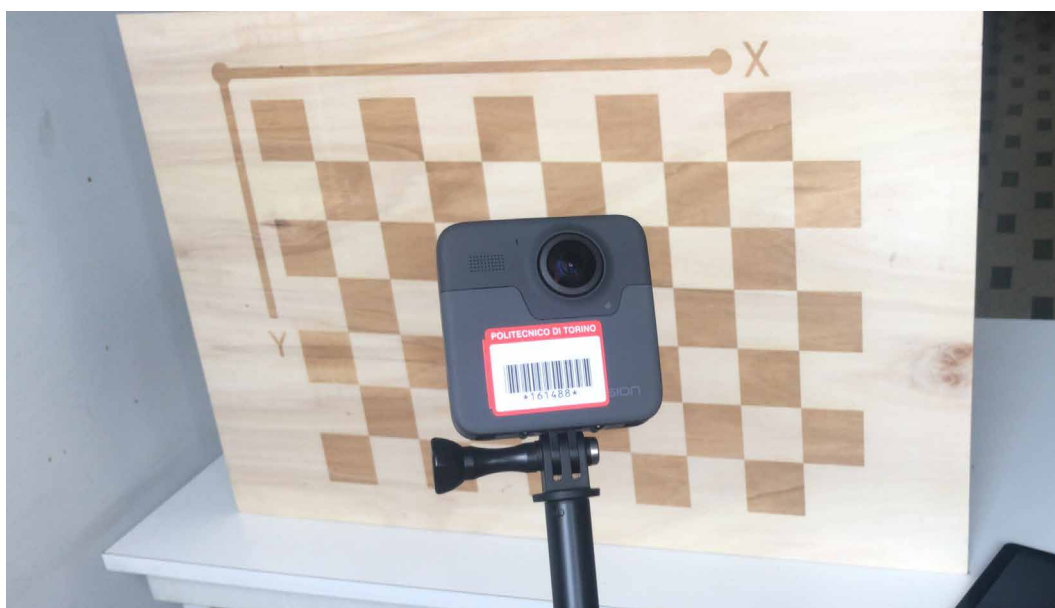
Fig. 63. Chessboard utilizzato per la stima dei parametri interni attraverso il Camera Calibration Tool di Matlab R2018a.
