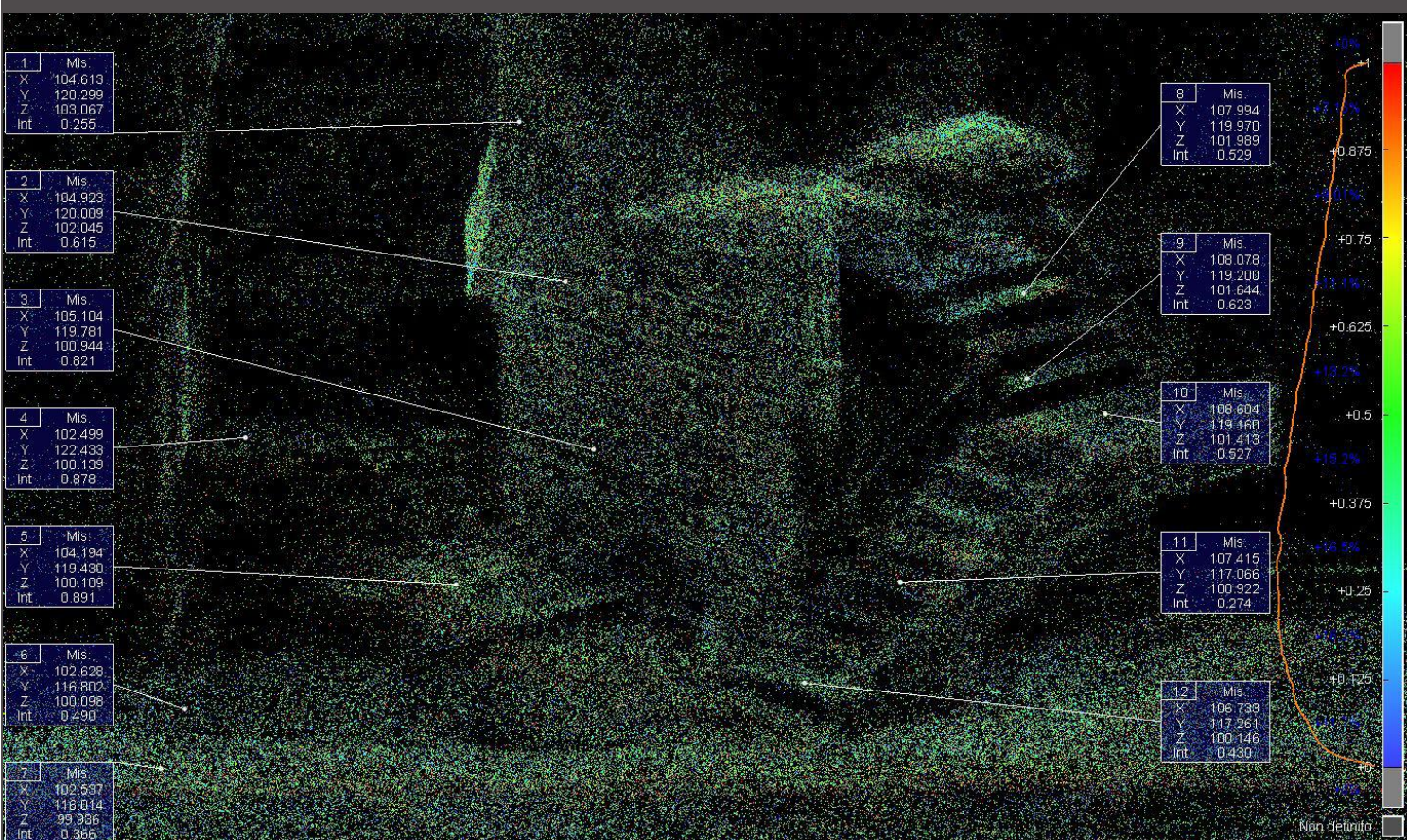
Fig. 119. Visualizzazione intensità degli errori di riproiezione relativi alla Camera Back con un valore di threshold di 1 pixel.
