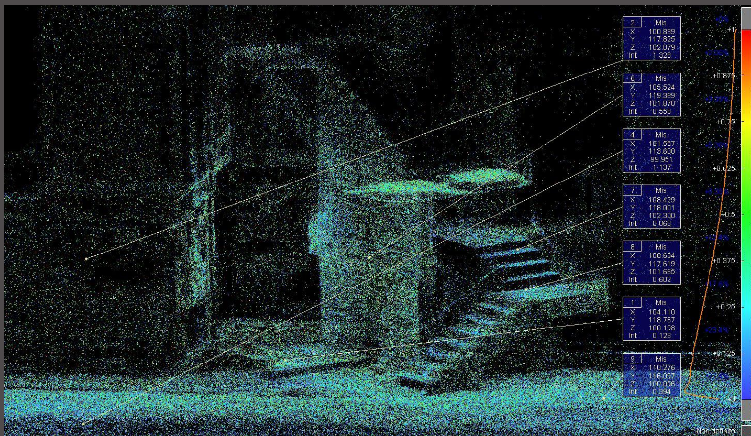
Fig. 121. Visualizzazione intensità degli errori di riproiezione relativi alla Camera Front con un valore di threshold di 1 pixel.
