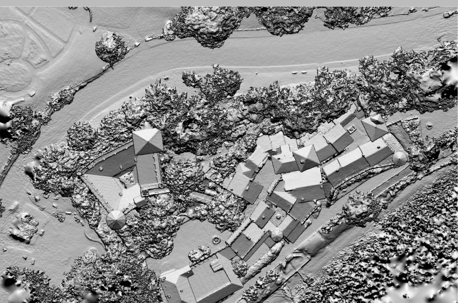
Fig. 351. Torino, Borgo Medievale, DSM ombreggiato realizzato attraverso fotogrammetria UAV in ambiente GIS.
