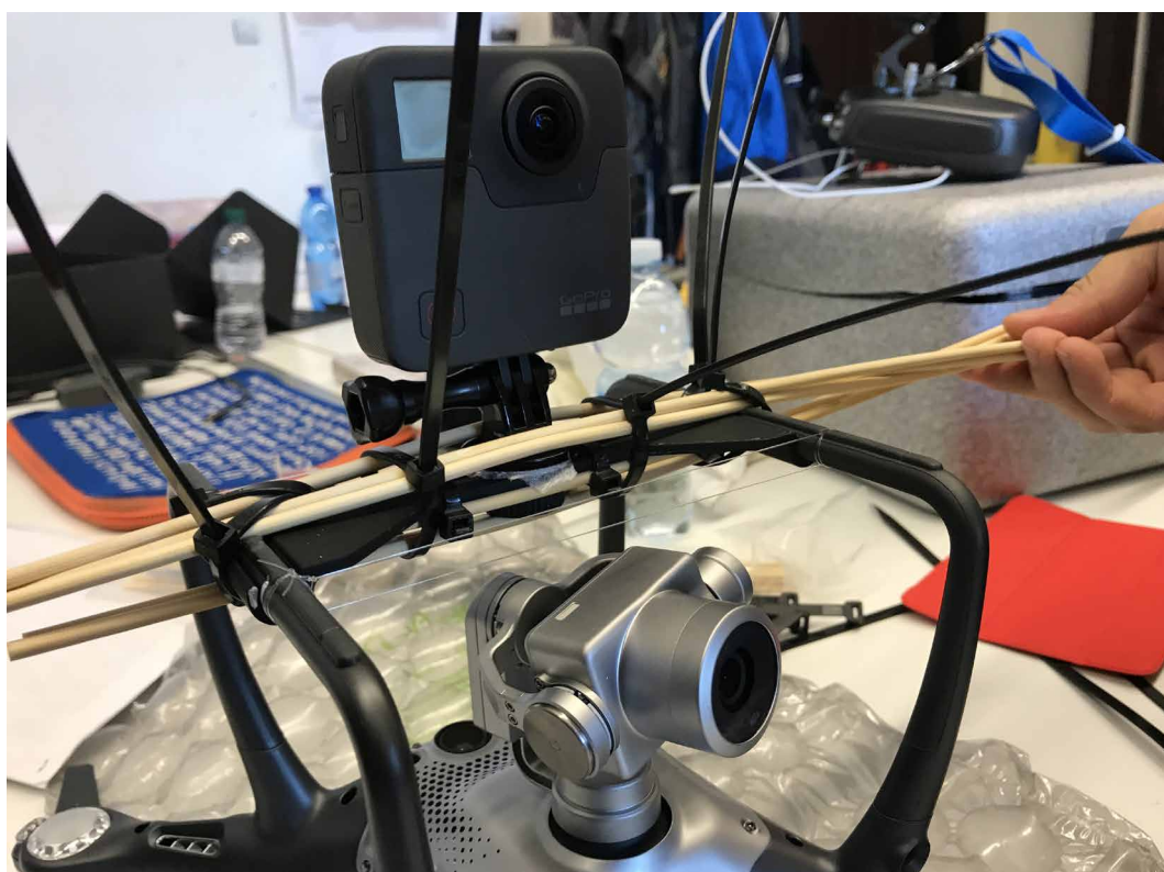
Fig. 222. Assemblaggio del prototipo di connessione Camera/Uav in laboratorio. Bacchette lignee di stabilizzazione.
