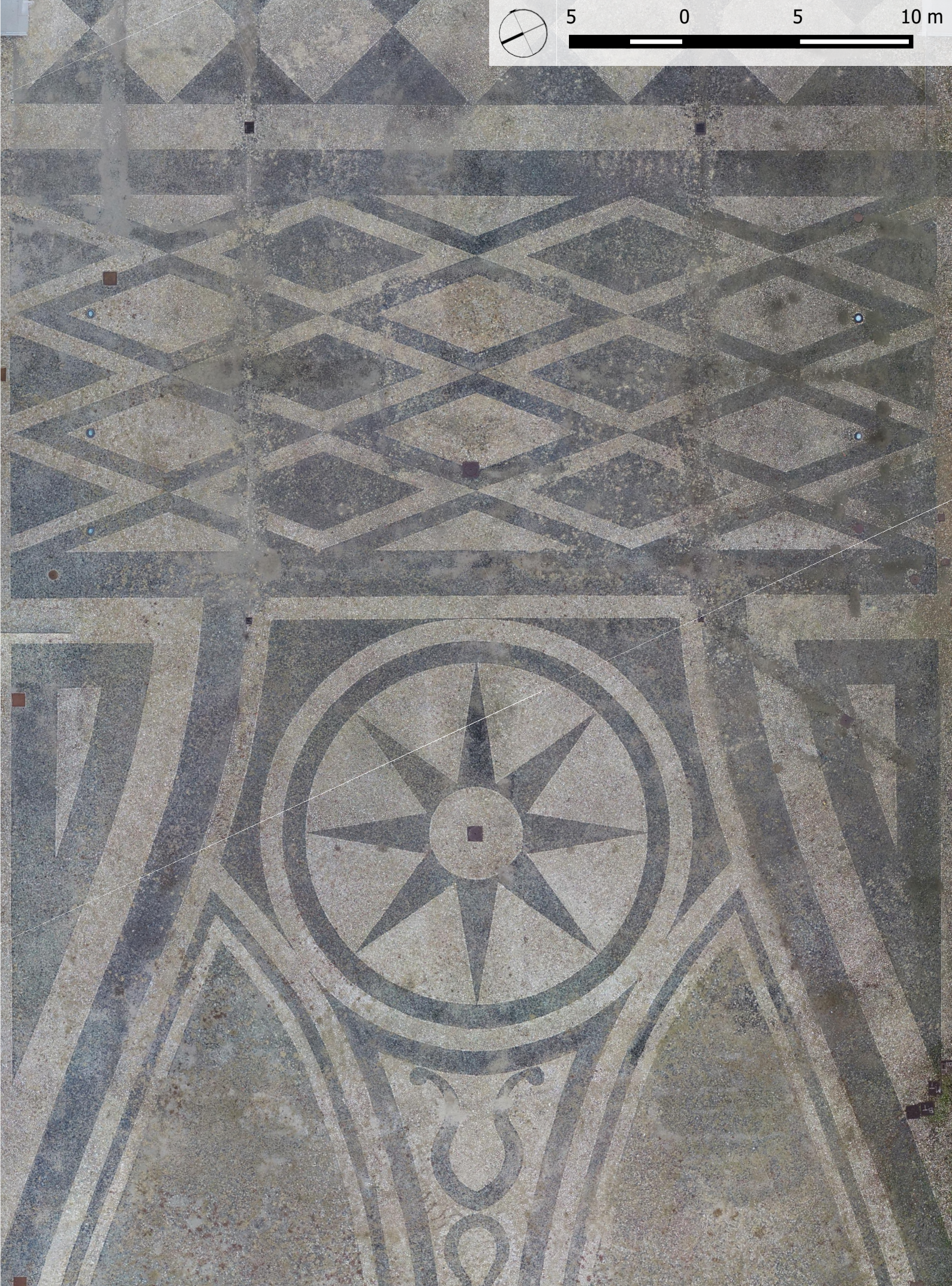
Fig. 328. Torino, Castello del Valentino , Ortofoto Dettaglio Pavimentazione (fuori scala); Realizzata attraverso l'integrazione delle immagini frame (nadirali+inclinate) e i panorami sferici acquisite da UAV.
