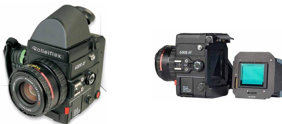
Fig. 9. Esempio della camera semimetrica ROLLEI 6008 Phase One . Formato sensore: 5440*4080 pixel 48.96 * 36.72 mm. Focale: 40 mm Dimensione pixel: 9 \mu m.
