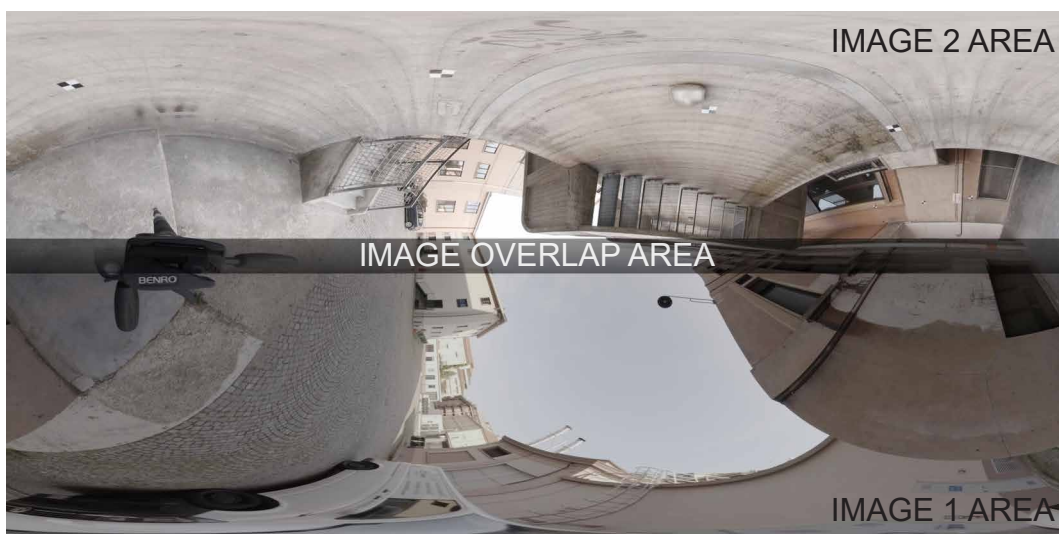
Fig. 184. In evidenza l'area di sovrapposizione (enfaticizzata) tra le immagini utilizzate per la determinazione della percentuale di sovrapposizione.
