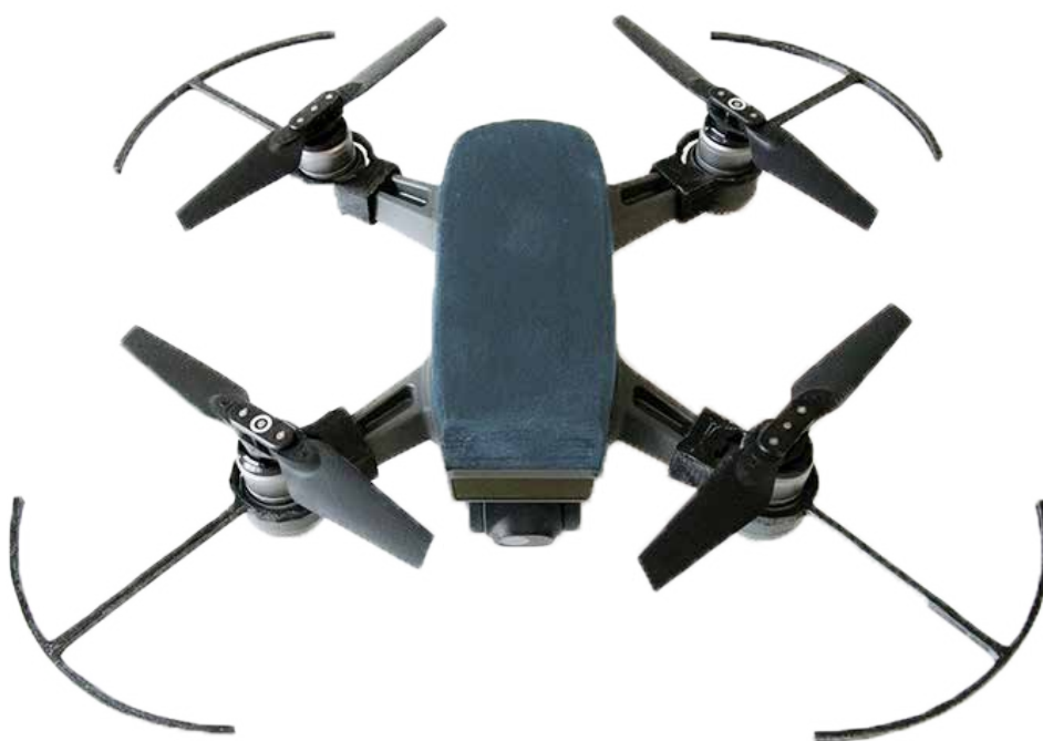
Fig. 272. Esempio dell'APR utilizzato (DJI Spark) appositamente alleggerito. Gli alleggerimenti sono stati realizzati tramite stampa 3d.
