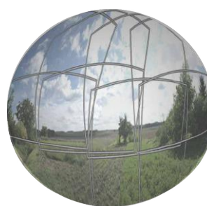
Fig. 159. Proiezione degli scatti su una sfera virtuale avente come raggio la lunghezza focale della camera.
