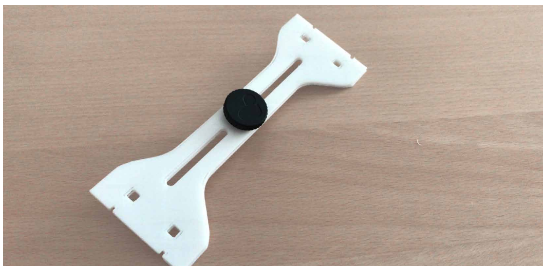
Fig. 212. Realizzazione prototipo di supporto tramite stampa 3d
