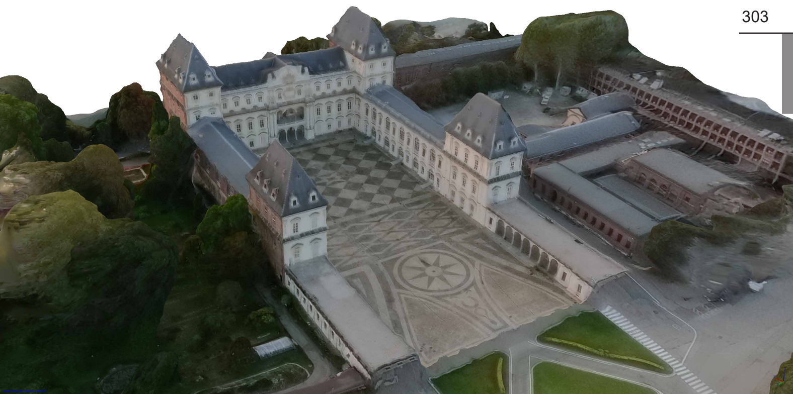
Fig. 294. Torino, Castello del Valentino , Visualizzazione a volo d'uccello del modello tridimensionale texturizzato generato attraverso le sole immagini sferiche acquisite da UAV.
