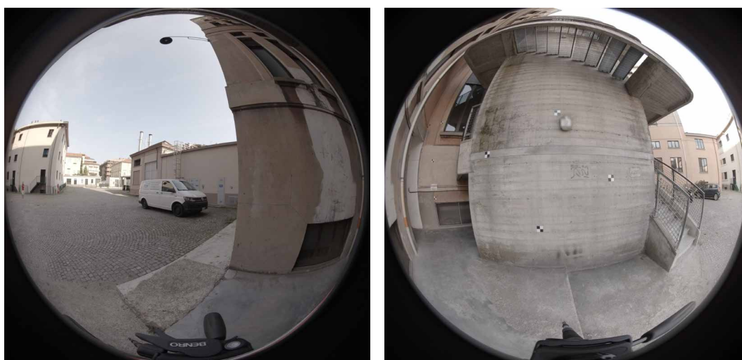
Fig. 170. Immagini utilizzate per il test di modalità di stitching alternative con inserimento dei parametri interni (Punto Principale, Distorsioni Radiali K_1/K_2/K_3 e Lunghezza Focale) per ciascuna delle due camere.
