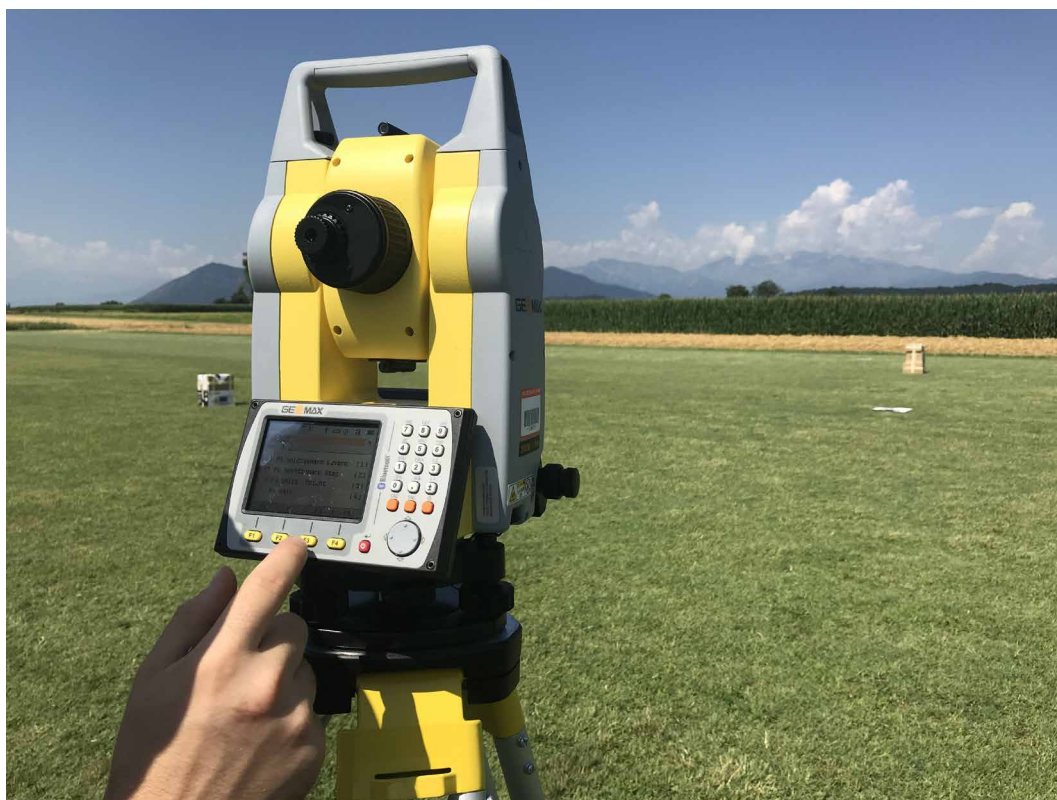
Fig. 235. Utilizzo della stazione totale per la misura di coordinate di punti a terra.
