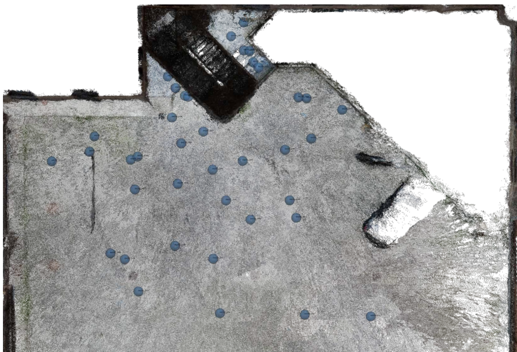
Fig. 188. Test ricostruzione tridimensionale utilizzando tutti i fotogrammi sferici acquisiti, nello specifico 53 proiezioni equirettangolari generate a partire da 106 fotogrammi fisheye .
