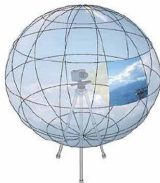
Fig. 158. Acquisizione delle immagini per la realizzazione del panorama sferico tramite cavalletto. [Tratto da G.Fangi (2007) Dispense "La Fotogrammetria Sferica Una Nuova Tecnica Per La Documentazione Del Patrimonio Monumentale" Università Politecnica delle Marche.]
