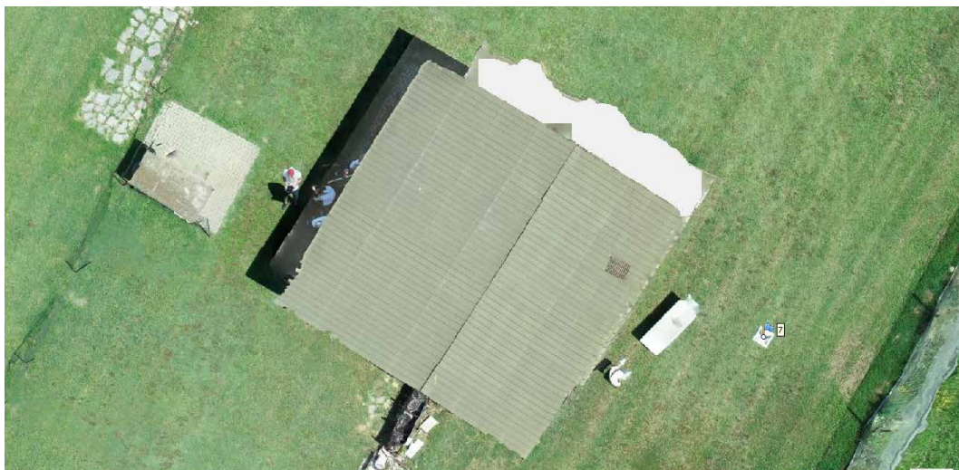
Fig. 259. Ortomosaico realizzato attraverso l'uso delle sole immagini a camera inclinata.
