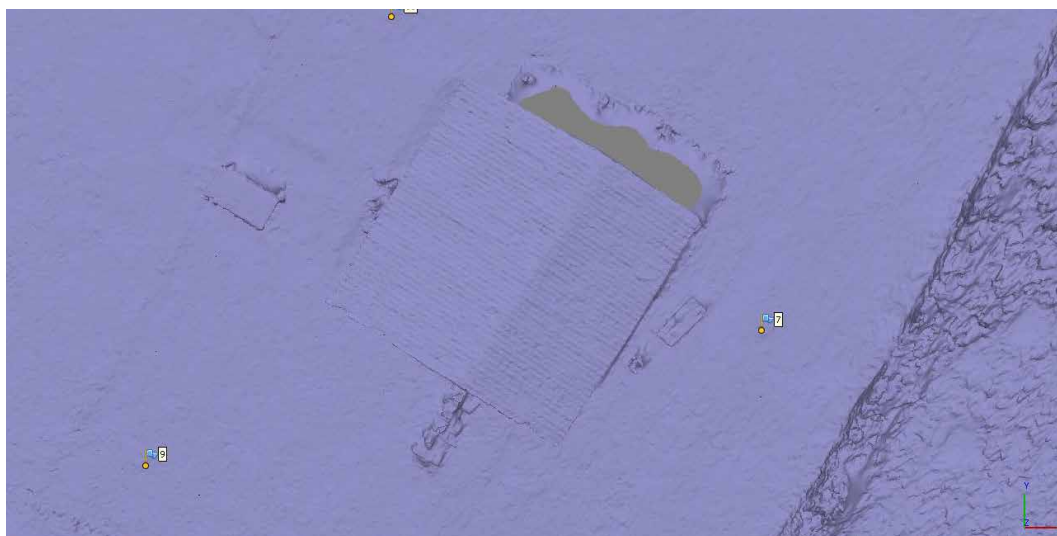
Fig. 256. Mesh realizzata attraverso l'uso delle sole immagini a camera inclinata.
