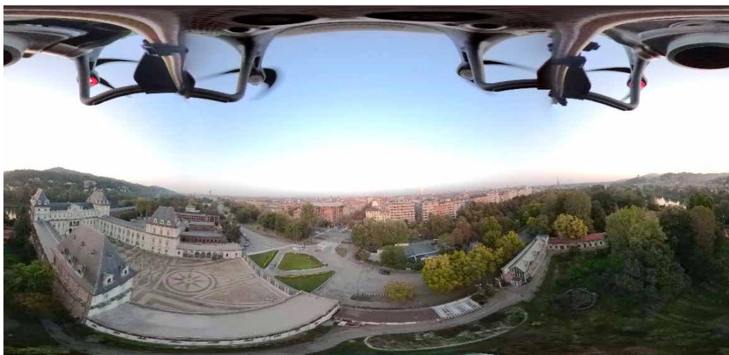
Fig. 289. Torino, Castello del Valentino , proiezione equirettangolare di un immagine sferica acquisita da UAV tramite la camera GoPro Fusion.
