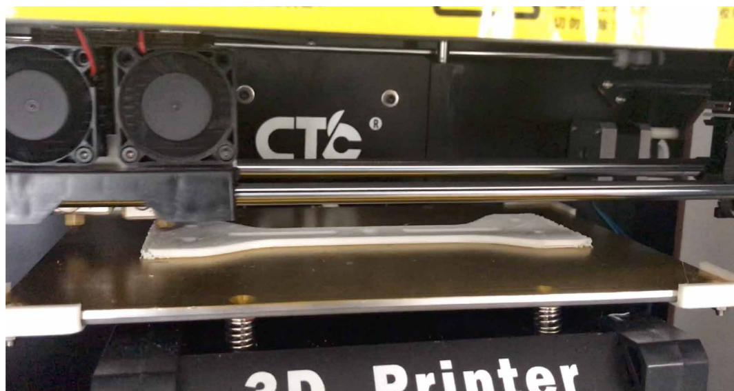
Fig. 210. Realizzazione prototipo di supporto tramite stampa 3d
