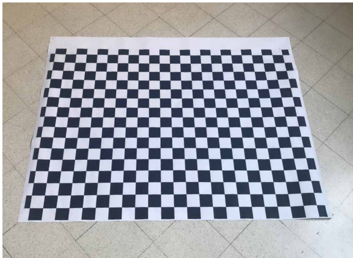
Fig. 78. Pattern di calibrazione per la stima dei parametri interni della camera fisheye tramite Agisoft Lens.
