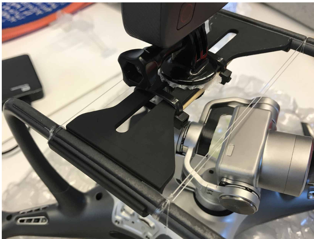
Fig. 219. Introduzione dei tiranti in nylon per stabilizzare il corpo camera.
