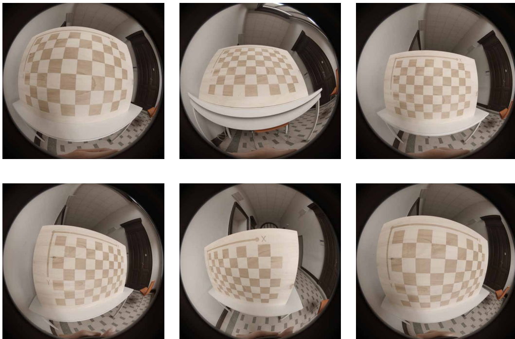
Fig. 67. Alcune immagini di esempio utilizzate per la calibrazione della camera attraverso il Camera Calibration Tool Matlab R2018a .
