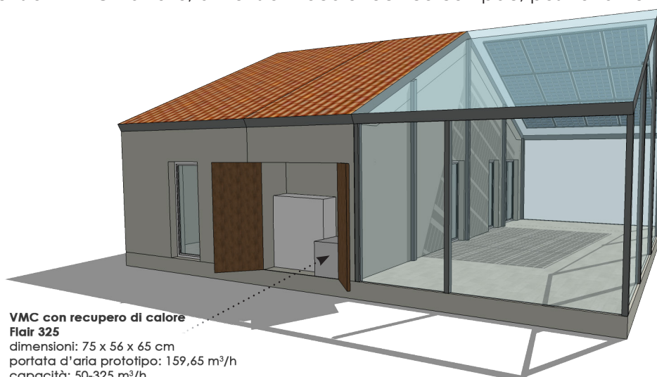
posizionamento VMC nel locale tecnico
