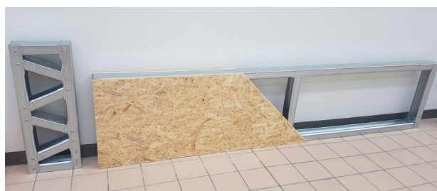
solaio in legno con travi reticolari, parete in legno con pilastri cavi, parete in legno con pilastri a T, solaio in legno con travi a T, trave reticolare in acciaio, telaio in acciaio rivestito in OSB
