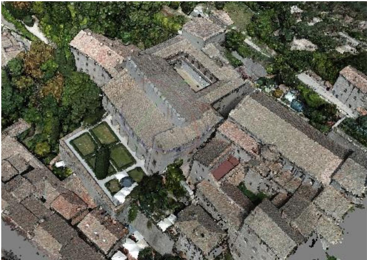
*Figura 25 Nuvola di punti Densa, 16.846.365 points, Processing: Medium quality*
