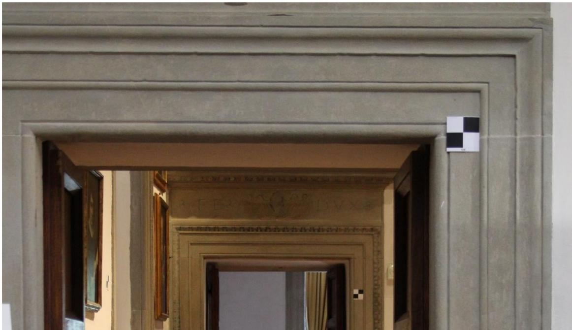
*Figura 12* Disposizione del target a scacchiera n. 100 sulla cornice di una porta interna
