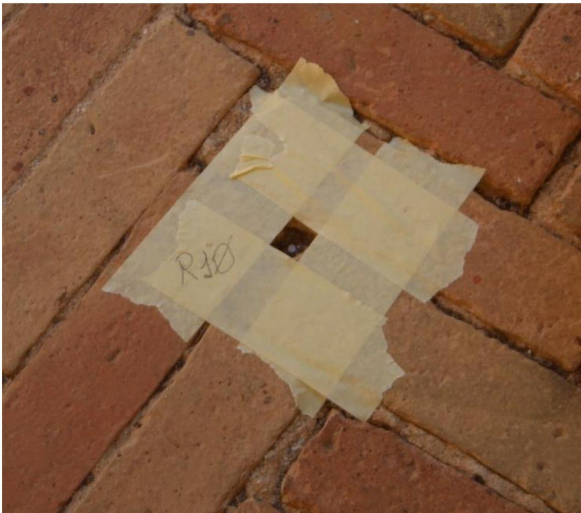
*Figura 11 Materializzazione del vertice topografico R10 attraverso chiodino*
