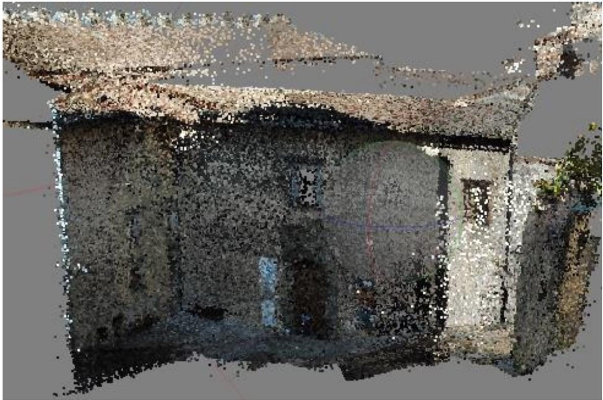
*Figura 36 Nuvola di punti Rada chunk\_3\_Ingresso, 2.339.366 points*
