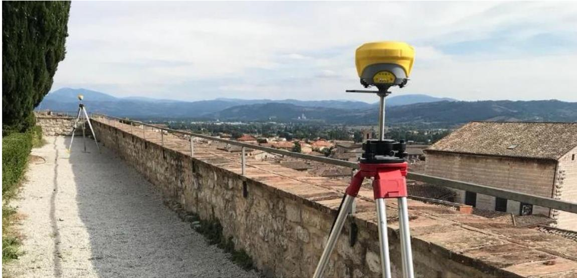
*Figura 10 Stazione GNSS durante il rilevamento del vertice topografico R8*
