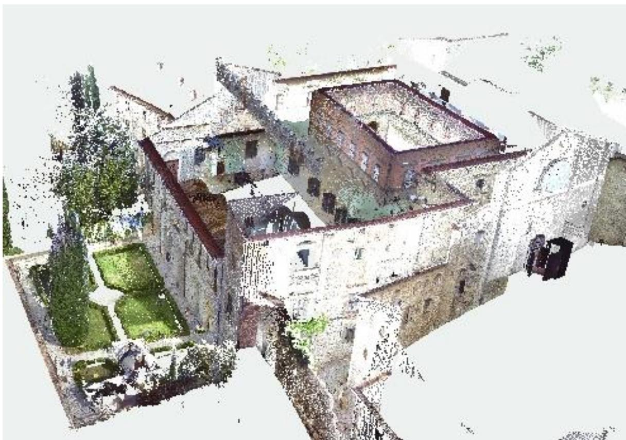
*Figura 16 Nuvola di punti Progetto\_1*
