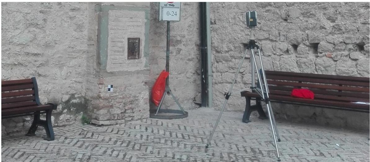
*Figura 15 Strumentazione durante l'acquisizione di una scansione*
