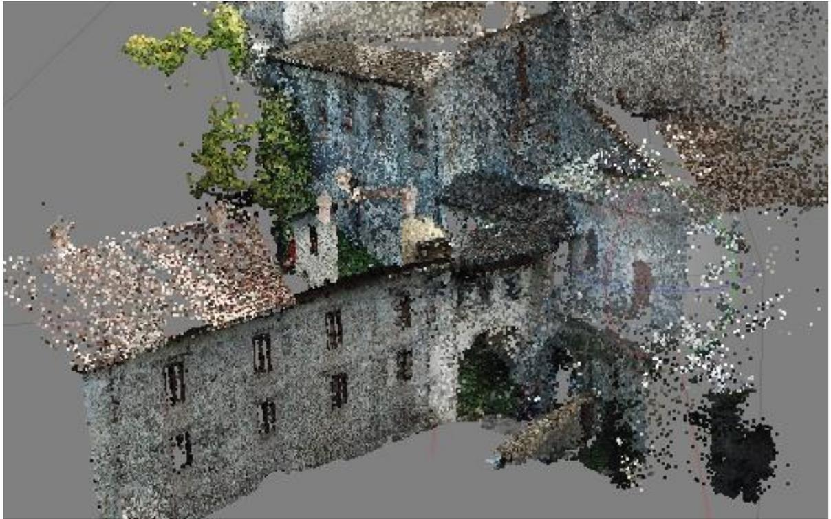
*Figura 28 Nuvola di punti Rada chunk\_1\_Loggia, 1.848.737 points*
