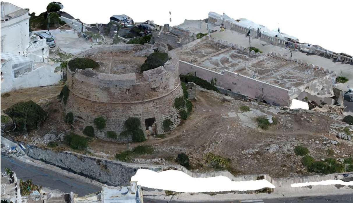
Fig. 66: Il modello 3D in forma di mesh texturizzata renderizzato in una vista a volo d'uccello con il software Agisoft Photoscan.
