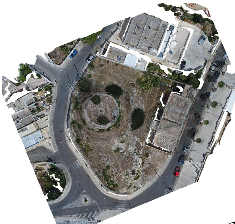
Fig. 67: Ortofoto del sito ottenuta dal modello 3D con il software Agisoft Photoscan.
