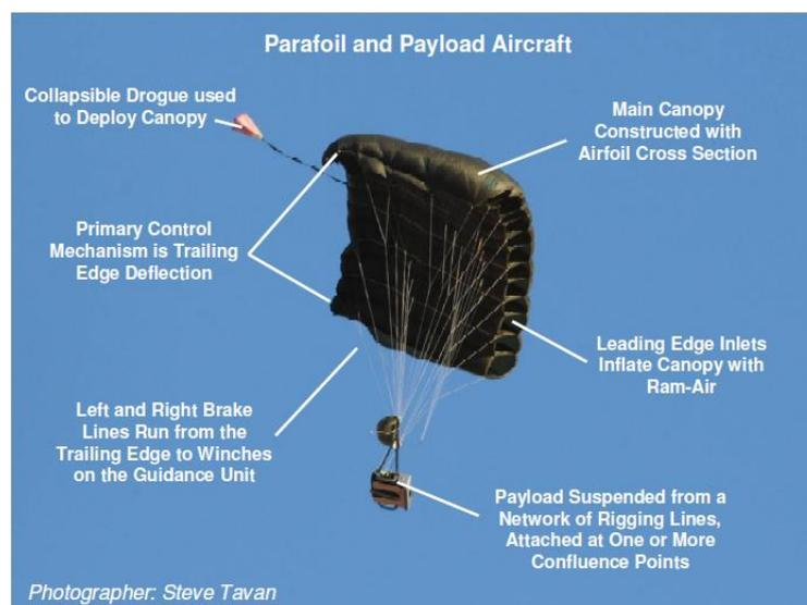
**Figura 1.** Descrizione grafica dei componenti del parafoil
