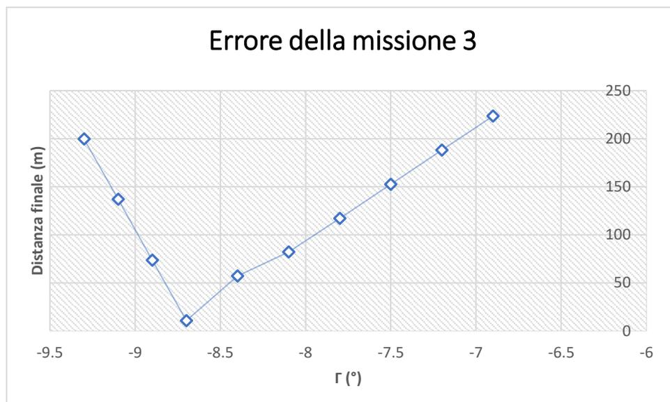
*Figura 76. Grafico della precisione del sistema parafoil-payload in funzione dell'angolo d'incidenza, per la missione 3 (altitudine di 6000 m)*
