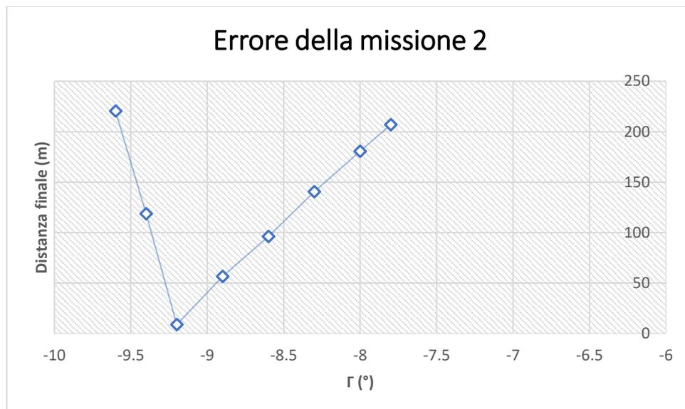
**Figura 75.** Grafico della precisione del sistema parafoil-payload in funzione dell'angolo d'incidenza, per la missione 2 (altitudine di 5000 m)
