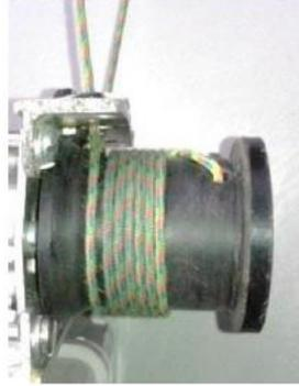
*Figura 14. Argano con avvolgimento della linea di un freno del parafoil*
