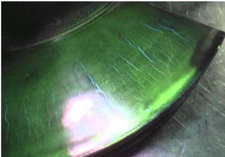
Figura 3.3. Esempio di presenza di cricche rilevabili con controllo magnetoscopico [21]
