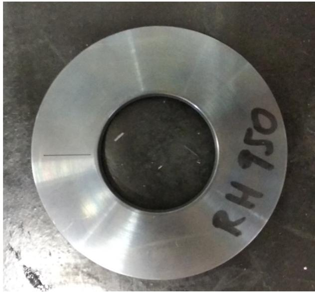
Figura 2.18. Molla con intaglio trattata termicamente RH950
