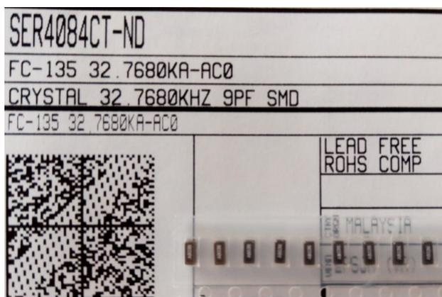
Figura 3.44: Oscillatore al quarzo da 32.768 KHz
