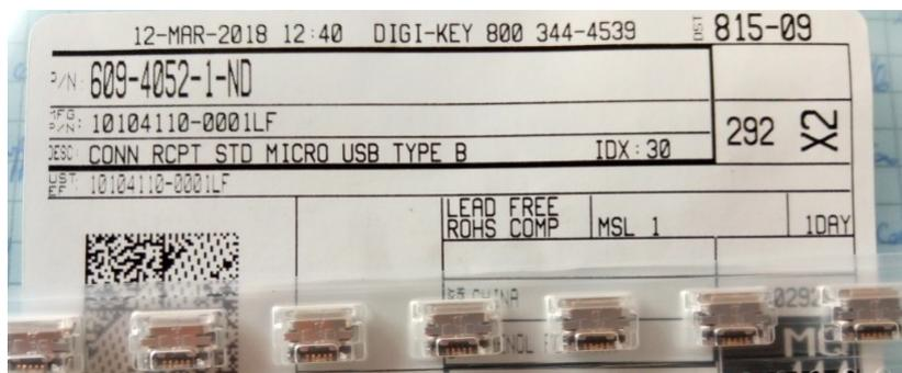
Figura 3.43: micro USB tipo B
