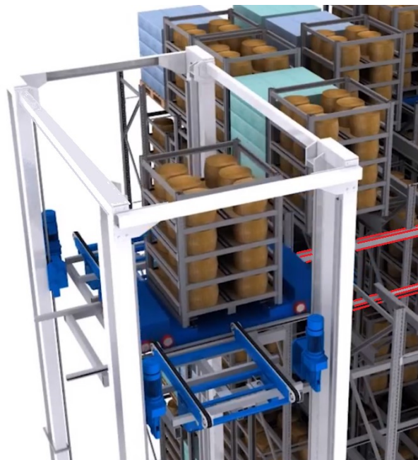
Figura 2.8 - Rappresentazione di un lifter
