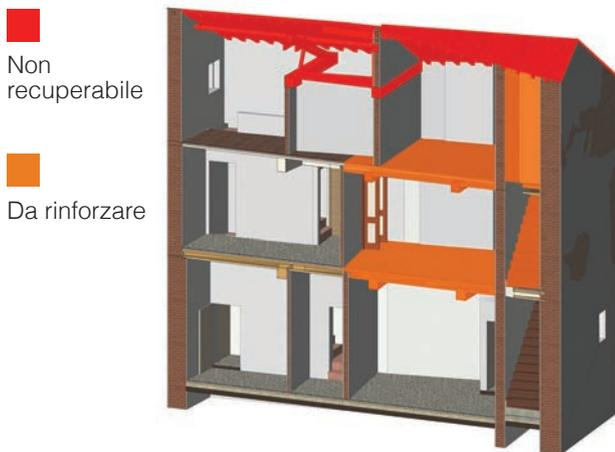
Fig. 57 - Spaccato assometrico del modello con individuazione delle strutture da rinforzare e demolire. Elaborazione dell'autore.
