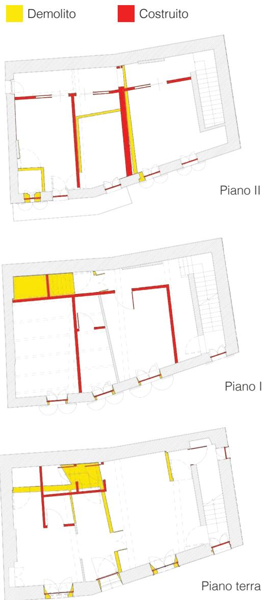
Fig. 56 - Planimetrie in cui vengono evidenziate le demolizioni e le nuove costruzioni. Elaborazione dell'autore
