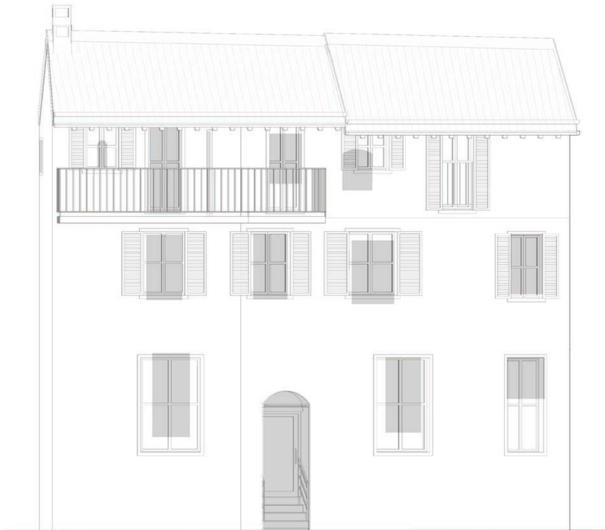
Fig. 58 - Prospetto dello *Stato di Progetto* in cui compaiono in grigio le vecchie bucaure. Elaborazione dell'autore
