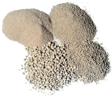
Fig. 60 - Tipologie di termointonaco con grana diversa
