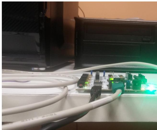
Figura 16: Led destro arancione lampeggiante stato dati e 100 Mb/s, fra una trasmissione e l'altra.
