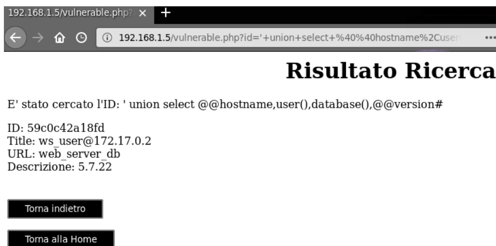
Figura 4.5. Dimostrazione del successo dell'attacco SQL Injection.
