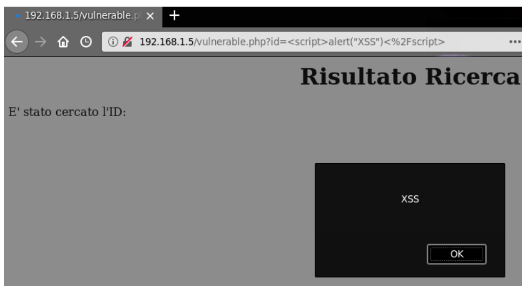
Figura 4.6. Dimostrazione del successo dell'attacco Reflective XSS.
