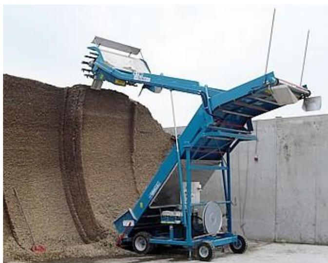
*Figura 2.1: Desilatore-caricatore semovente.*
