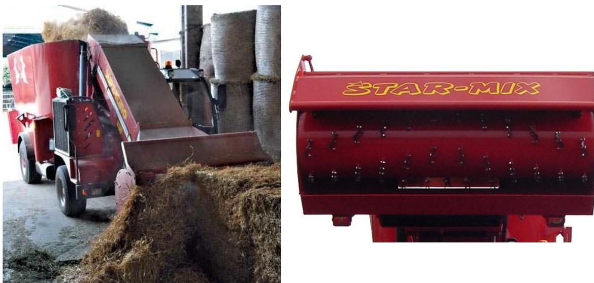
Figura 2.13: A sinistra: Fase di carico della paglia tramite apparato desilatore. A destra: Fresa desilatrice.
