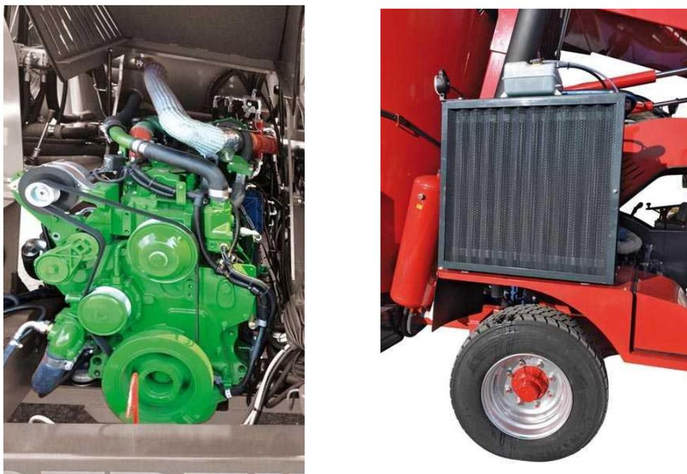
Figura 2.7: A sinistra: Motore endotermico a gasolio. A Destra: Radiatore ad acqua.
