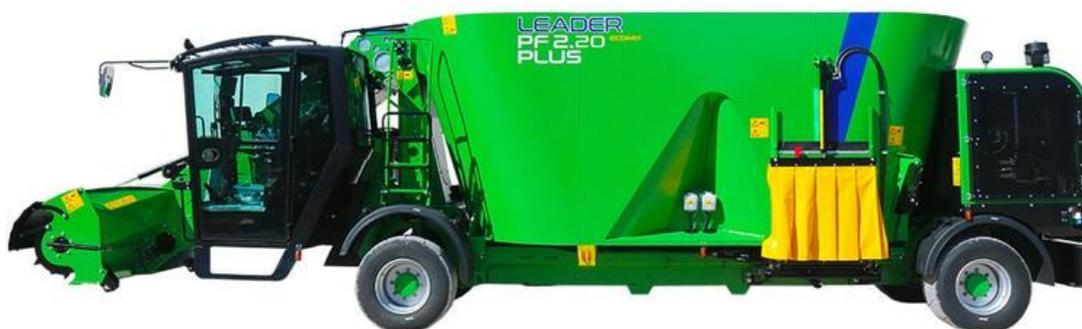
Figura 4.2: Carro trincia miscelatore semovente con motore posizionato posteriormente.
