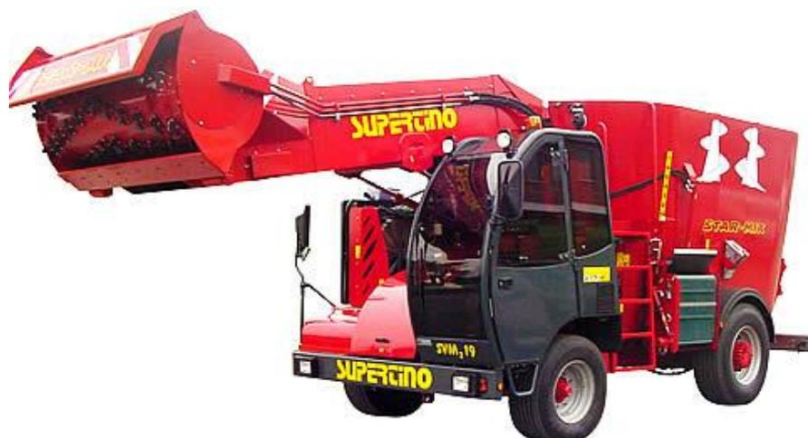
Figura 4.1: Carro trincia miscelatore semovente con motore posizionato anteriormente.
