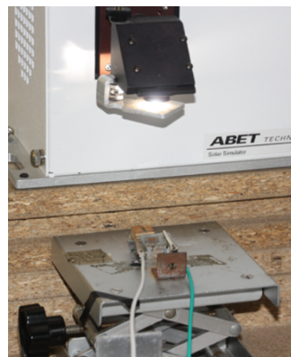
Figura 4.12 Cella in silicio per la calibrazione dello strumento (a sinistra), collegamento della DSSC al SMU tramite morsetti (a destra).
