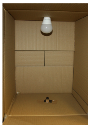
Figura 4.13 Filtri ottici per schermare parte della radiazione emessa dalla lampada e cabina di test per simulare la luce in un ambiente interno.
