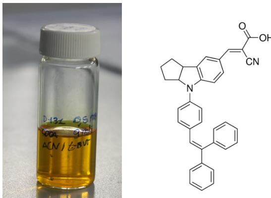
Figura 4.7 Soluzione di colorante D131 e sua struttura chimica [91].
