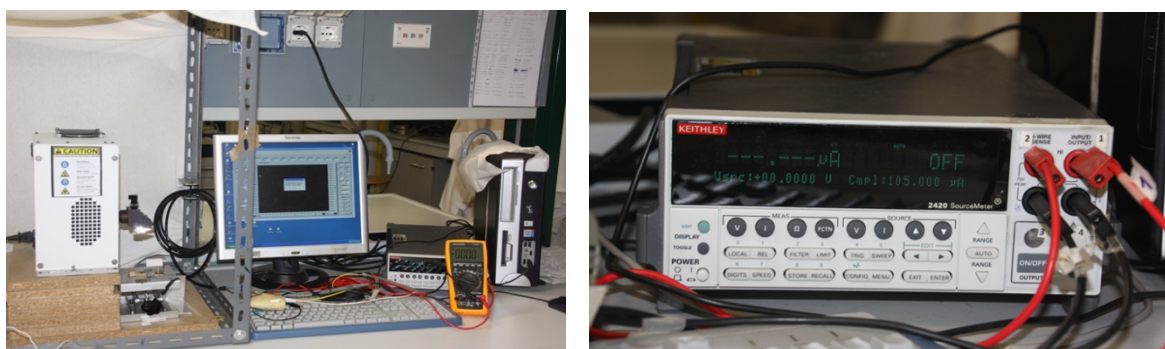
Figura 4.10 Strumenti necessari per la misura dei parametri fotovoltaici e particolare del SMU.
