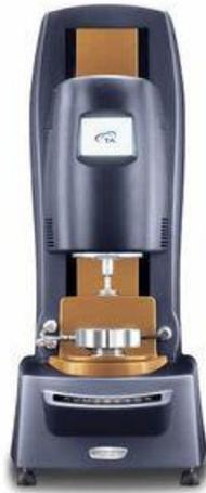
Figura 3.9 Reometro DHR-2(TA instruments).[122]
