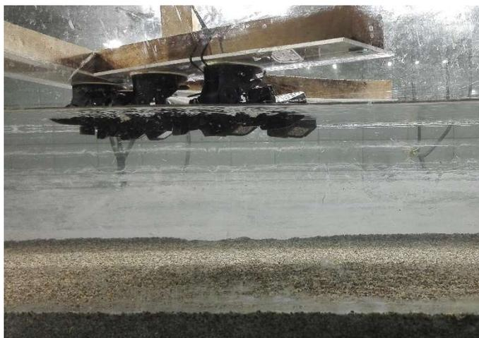
*Figura 16: Le GoPro sono posizionate all'interno del flusso idrico in modo da garantire la completa immersione della focale con un affondamento limitato entro pochi centimetri dalla superficie libera.*
