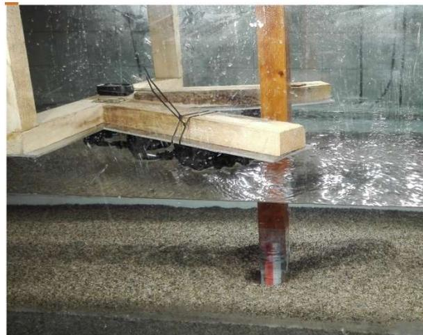
*Figura 11: Posizionamento della pila sperimentale e avviamento della prova di erosione.*
