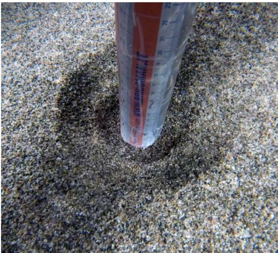
*Figura 28: Nastri graduati applicati alla pila, sul lato monte e al finaco, per l'esecuzione di letture di profondità di erosione a ridosso della pila.*
