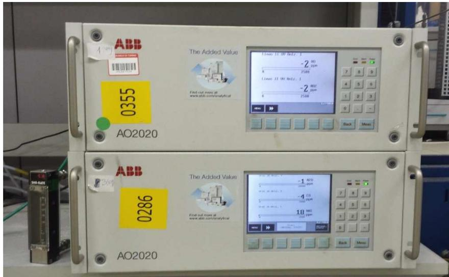
**Figura 4.7:** Analizzatore a gas UV Limas (superiore) ed analizzatore a gas Uras (inferiore)
