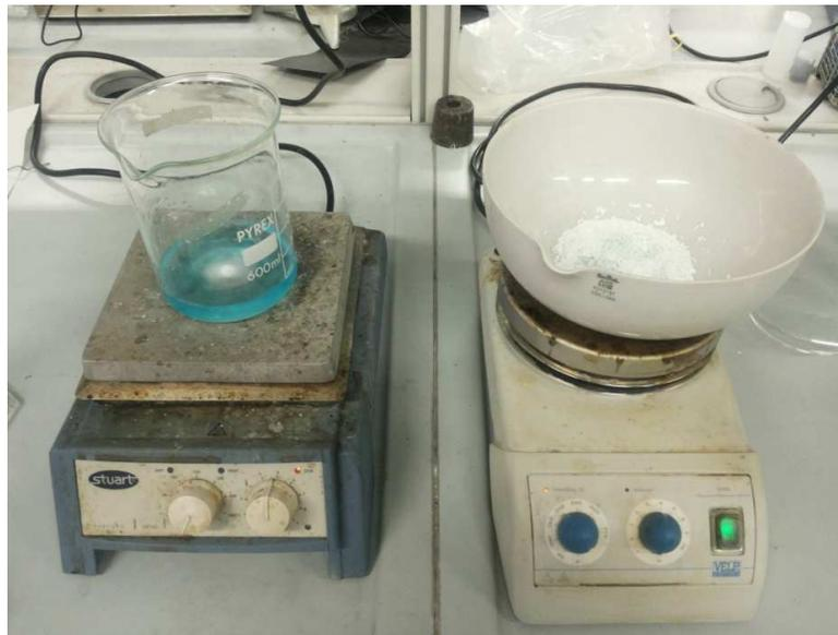
*Figura 3.2: Preparazione del catalizzatore con il metodo dell'impregnazione*
