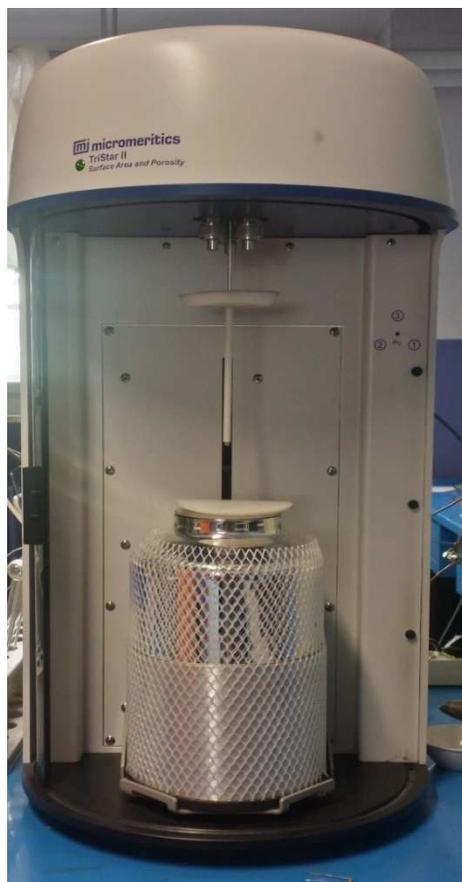
*Figura 4.3: Analizzatore Micromeritics Tristar 3020*
