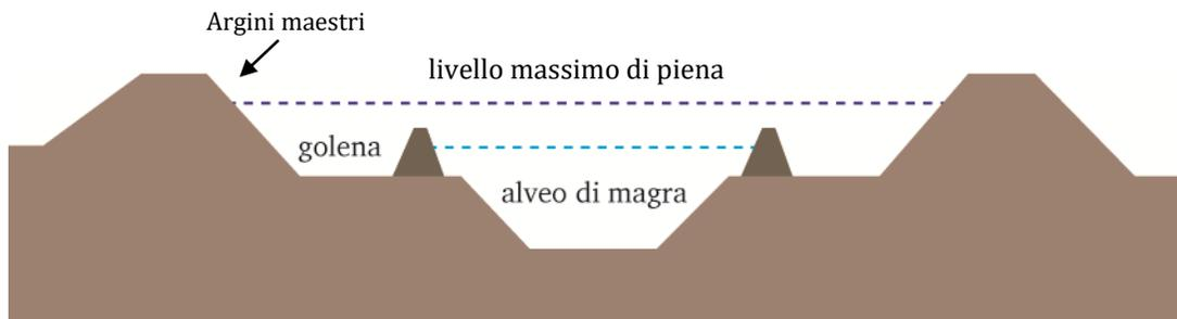
**Figura 4** Sezione trasversale di un alveo di un fiume con argini longitudinali, goleni e maestri
