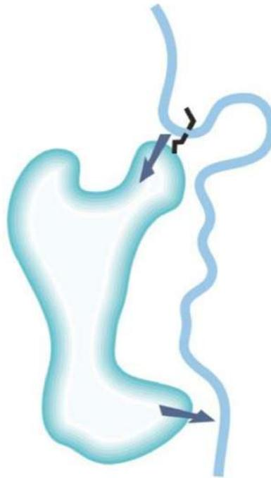
**Figura 6** Schema di cassa di espansione in derivazione. Fonte: Parco della Lura (<http://www.parcollura.it>)
