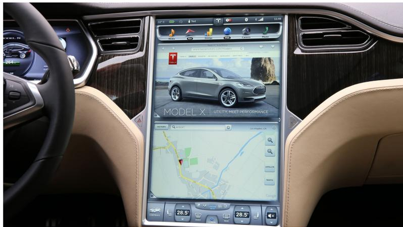
Figura 2.8: Il touch screen centrale della Tesla: esempio di integrazione di più funzioni in contemporanea.
