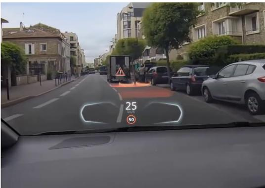
Navigazione Assistita, LKA, ACC, Rilevamento pedoni, Avviso di ostacolo in avvicinamento
