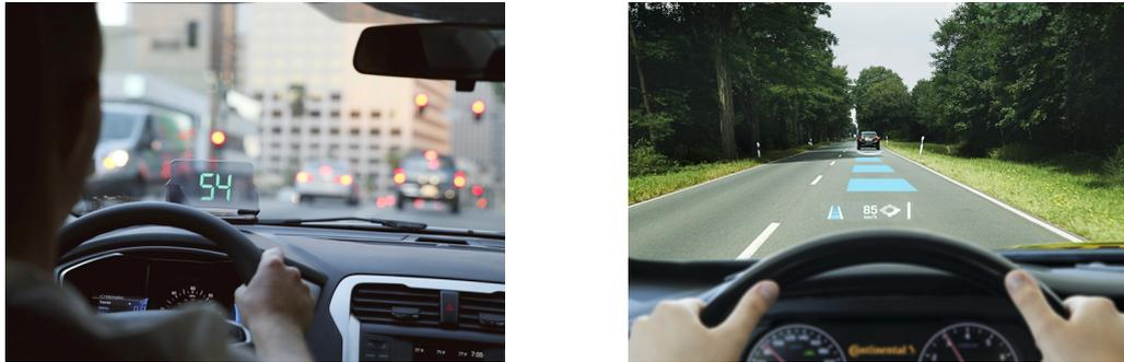
(a) HUD non in modalità contact-analog.      (b) HUD in modalità contact-analog.
