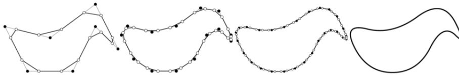
Figura 4.16: Applicazione ripetuta dell'algoritmo di Chaikin.
