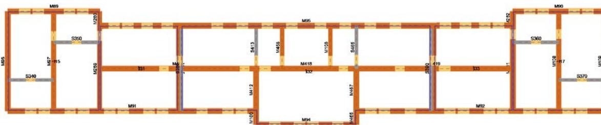
Figura 113 - Modello della pianta del primo piano con l’inserimento dei setti in c.a.
