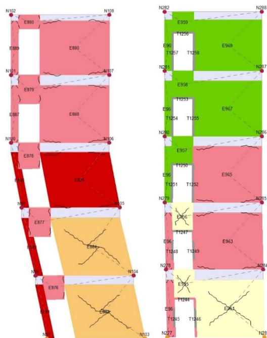
Figura 119 - Confronto verifiche pannello 13, sottoposto all'analisi 24, prima e dopo i rinforzi
