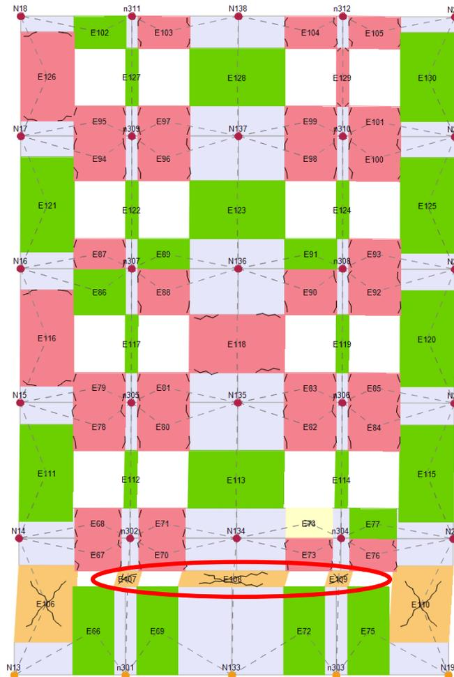
Figura 120 - Rottura fasce di piano e maschi a livello del seminterrato con l'analisi 20
