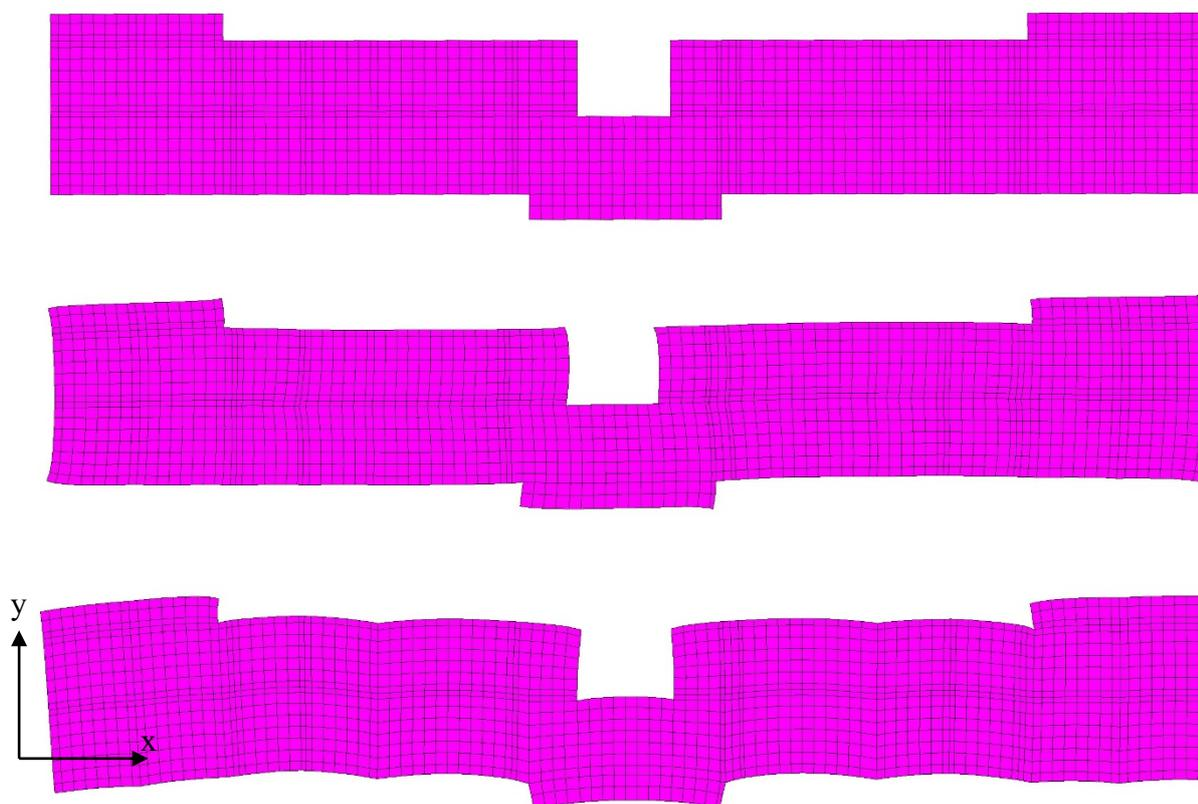
Figura 57 - Dall'alto verso il basso: deformazioni di piano nel modello rigido e nel modello deformabile con forze  $F_x$  e  $F_y$
