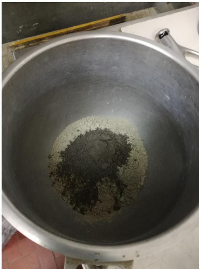
*Fig.4.11 Aggiunta di bio-char nel cemento*
