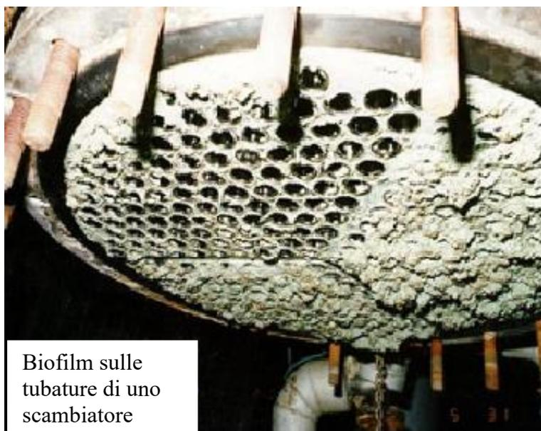
Biofilm sulle tubature di uno scambiatore
