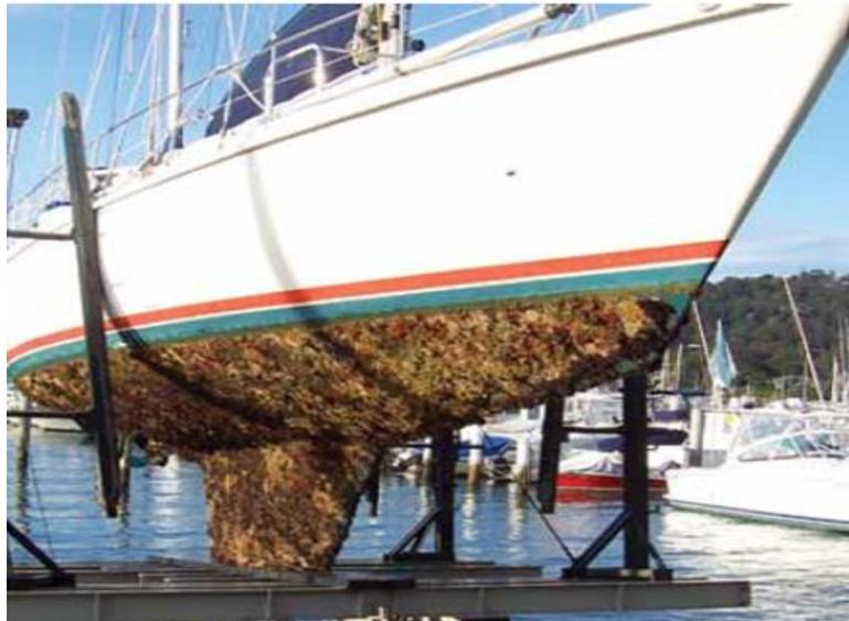
*Figura 1.5 Biofouling sviluppato sullo scafo di un'imbarcazione*
