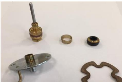
Figura 20-In alto, da sinistra verso destra: organo mobile dell'elemento di strizione, filtro, sede dell'elemento di strizione; in basso, da sinistra verso destra: elemento separatore ambiente di valle-camera diaframma con tubicino di presa pressione, guarnizione.
