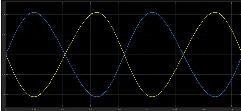
*Figura 5.23 – Velocità dei due pistoni, sospensione anteriore*
