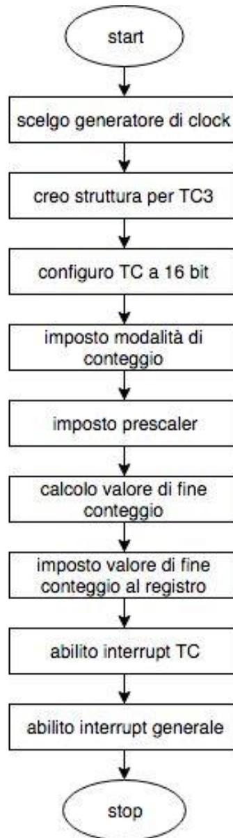
**Figura 43:** diagramma della subroutine per le inizializzazioni del timer
