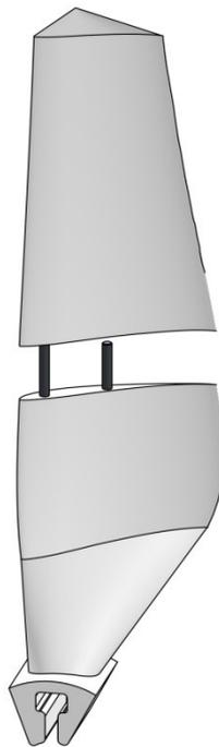
**Figura 5.8 - Montaggio, le barre filettate garantiscono l'allineamento mentre la colla garantisce l'unione delle parti**
