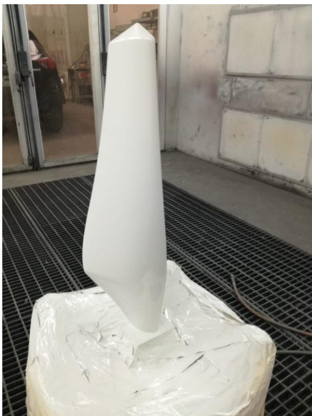
**Figura 5.29 - Fotografia della pala dopo la verniciatura e l'essiccazione**
