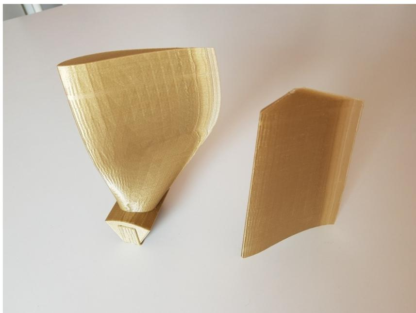
**Figura 5.9 - Fotografia della pala stampata in due parti**
