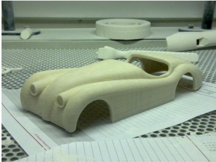
**Figura 4.11 - Modello pulito e trattato con infiltrante**
