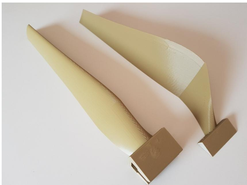
**Figura 5.18 - Pala stampata in due parti, divisa lungo la direzione longitudinale**
