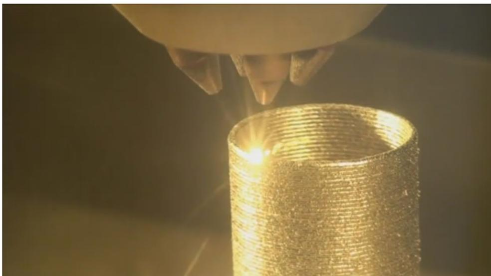
Figura 4.6 - Costruzione di un componente tramite tecnologia LENS. Fonte: [7]
