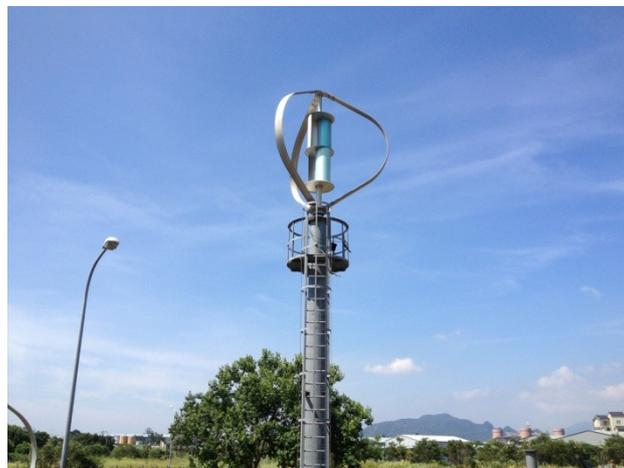
**Figura 1.12 - Turbina Savonius /  $\Phi$ -Darrieus, potenza nominale 700W. Fonte: [20]**
