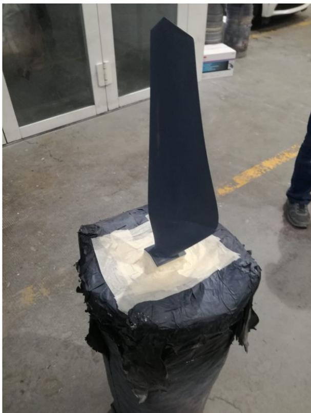
**Figura 5.26 - Fotografia della pala dopo l'applicazione del fondo catalizzato**
