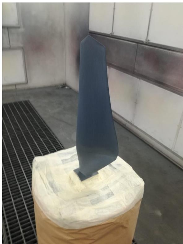
**Figura 5.28 - Pala dopo l'applicazione della seconda mano di fondo catalizzato e la seppiatura**
