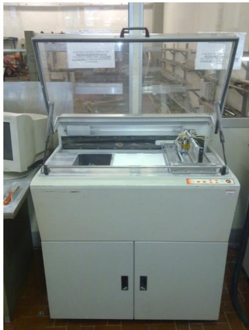
Figura 4.8 - Stampante 3 dimensional printing Z402 della 3D System
