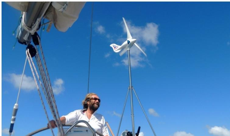
Figura 1.21 - Turbina microeolica installata su un'imbarcazione a vela. Fonte: [22]
