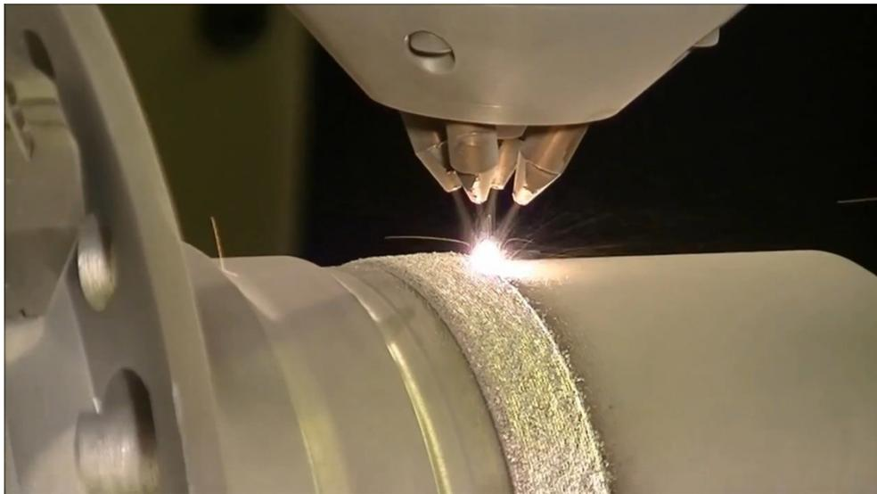
Figura 4.5 - Riparazione di un mozzo tramite tecnologia LENS. Fonte: [7]
