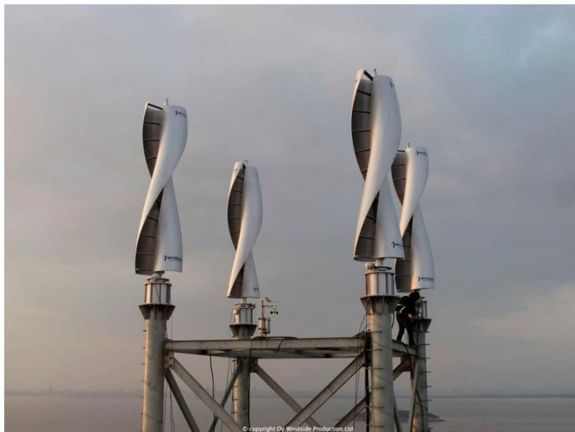
Figura 1.10 - Turbine Savonius. Fonte: [19]
