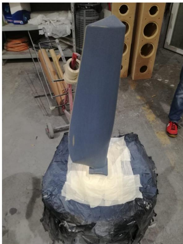
**Figura 5.27 - Pala dopo l'applicazione del fondo catalizzato e la seppiatura con carta abrasiva 400**
