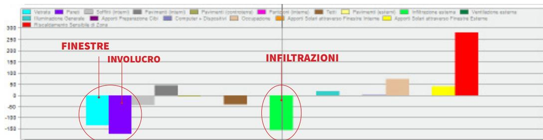
Fig.56: Il grafico illustra i totali delle dispersioni misurate a livello di edificio. Si possono evidenziare le criticità relative ai serramenti.
