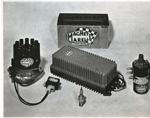
Figura 3-8: distributore, centralina, bobina e batteria Motorsport
