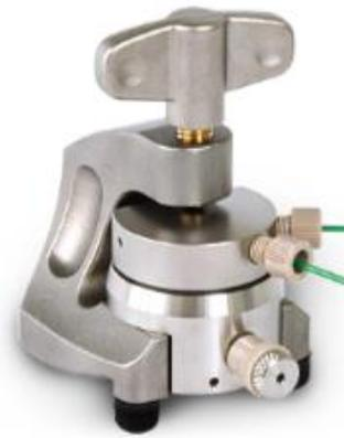
**Figura 4.8:** EL-Cell assemblata e pronta alla fase di test: i due tubicini verdi permettono l'entrata e l'uscita di ossigeno. <sup>[21]</sup>
