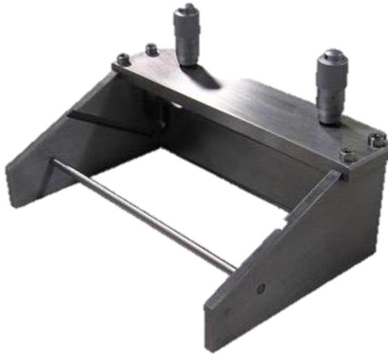
**Figura 4.1:** Doctor Blade utilizzato in laboratorio. <sup>[17]</sup>
