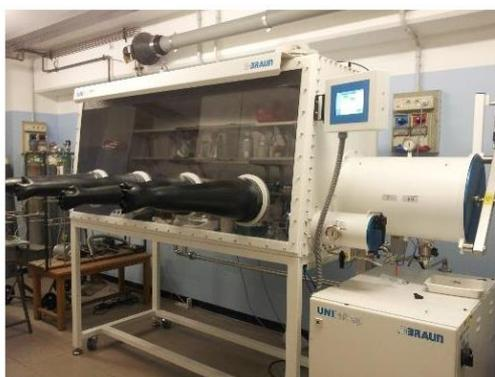
**Figura 4.3.** Glove Box della MBRAUN Labstar, presente nel laboratorio di elettrochimica del DISAT.
