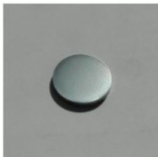
Figura 4.6 Campione in Ti6Al4V lucidato con carta abrasiva di numero di grana 4000.
