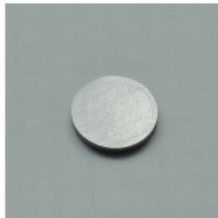
*Figura 4.4 Campione in Ti6Al4V lucidato con carta abrasiva di numero di grana 120*
