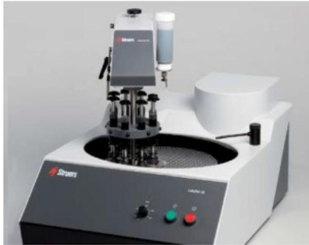
*Figura 4.3 LaboPol-2, macchina utilizzata per la lucidatura dei campioni [116]*
