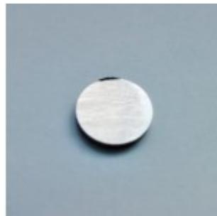
Figura 4.2 Campione in Ti6Al4V ricavato a seguito delle operazioni di taglio
