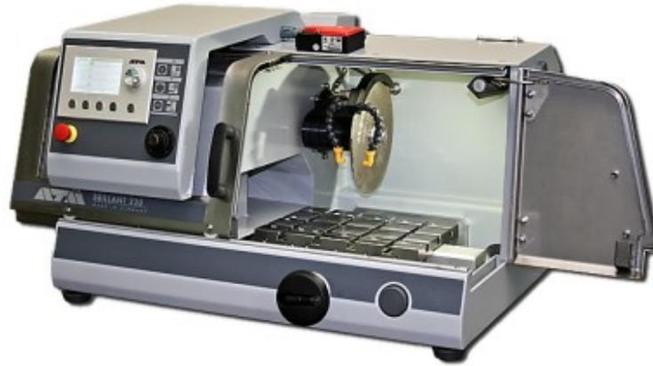
Figura 4.1 Brillant 220, macchina utilizzata per il taglio dei campioni [114]
