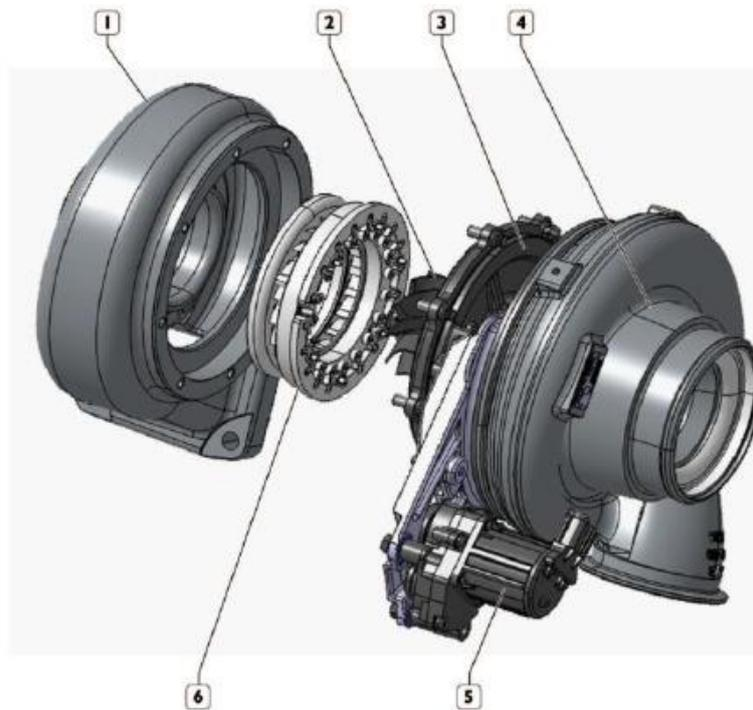
**Figura 4.21:** Componenti di un Turbocompressore E-VGT 1. Voluta della turbina; 2. Girante della turbina; 3. Corpo centrale; 4. Voluta del compressore; 5. Attuatore elettrico; 6. Dispositivo variazione orientamento palette. [11]
